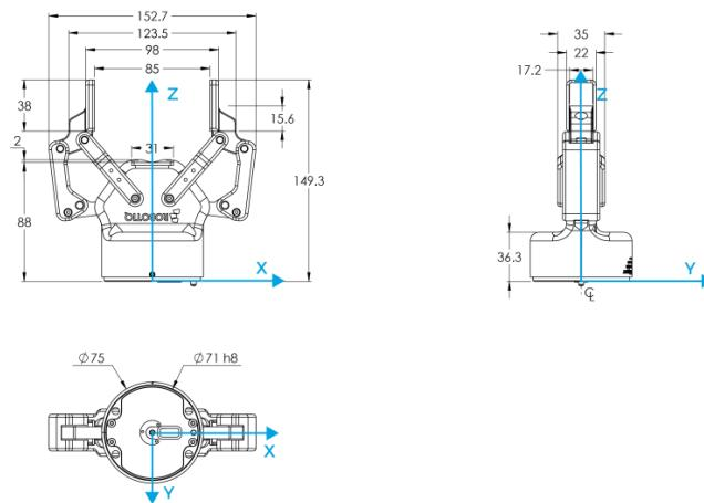
Slika 3.11 Dimenzije hvataljke *Robotiq 2F-85* [28]
