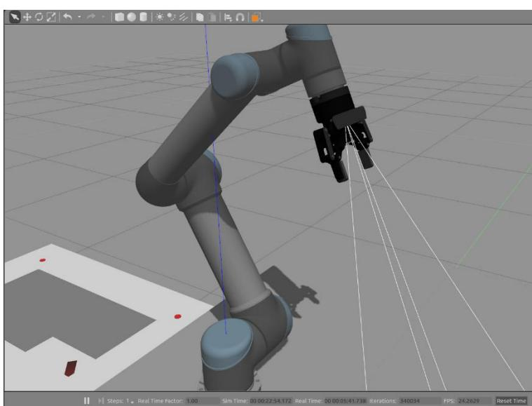
**Slika 3.12 Robotski sustav - konfiguriran za Gazebo simulaciju**
