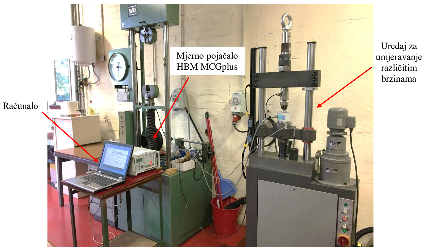
Slika 26. Kompletan sustav za provođenje umjeravanja različitim brzinama
