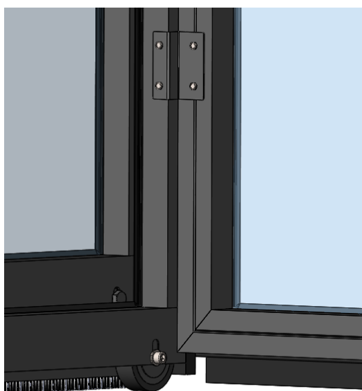
Slika 36. Vijčani spoj fronte i bočnog okvira preko spojnog lima
