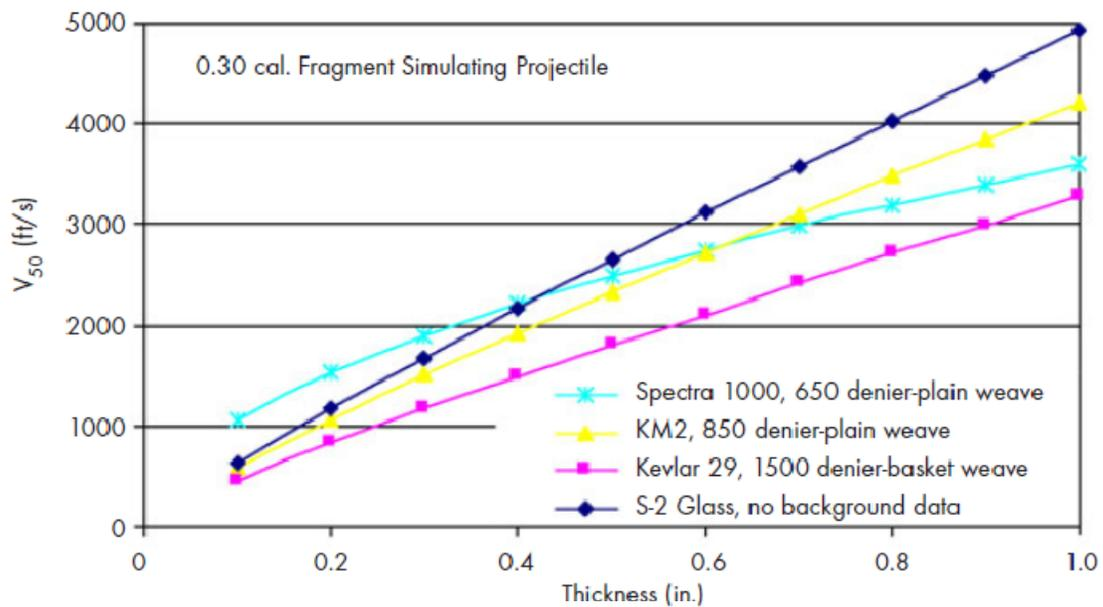
(b)  $V_{50}$  versus ThicknessSlika 7.3 [12] Rezultati  $V_{50}$  testa s obzirom na debljinu kompozita za različite vrste kompozita
