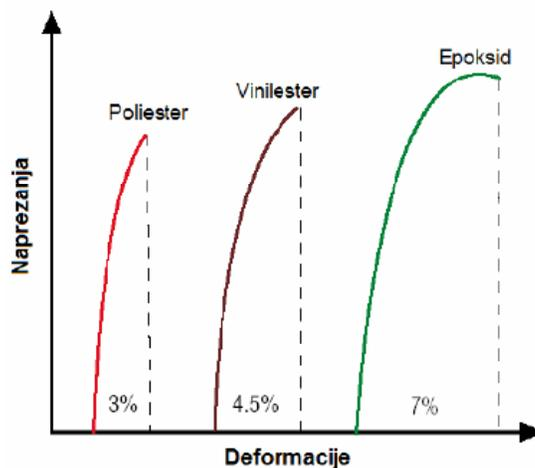
**Epoksidne smole** su najčešće upotrebljavane duromerne matrice zbog svojih dobrih mehaničkih svojstava, dobre postojanosti na agresivne medije, visoke toplinske postojanosti, lakog korištenja, a i dobro reagiraju s većinom vrsti vlakana. Glavni nedostaci jesu visoka cijena proizvodnje u odnosu na ostale vrste duromernih smola, osjetljivost na vlagu, sporo polemeriziranje, mala otpornost nekim organskim spojevima (organskim kiselinama i fenolima) te relativno niska najviša temperatura primjene.
