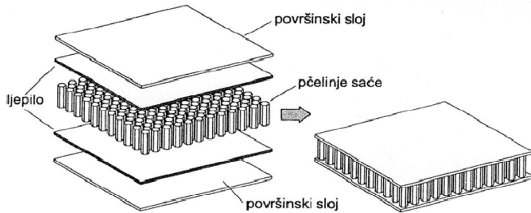
Slika 5.1 [13] Shematski prikaz saćaste sendvič konstrukcije
