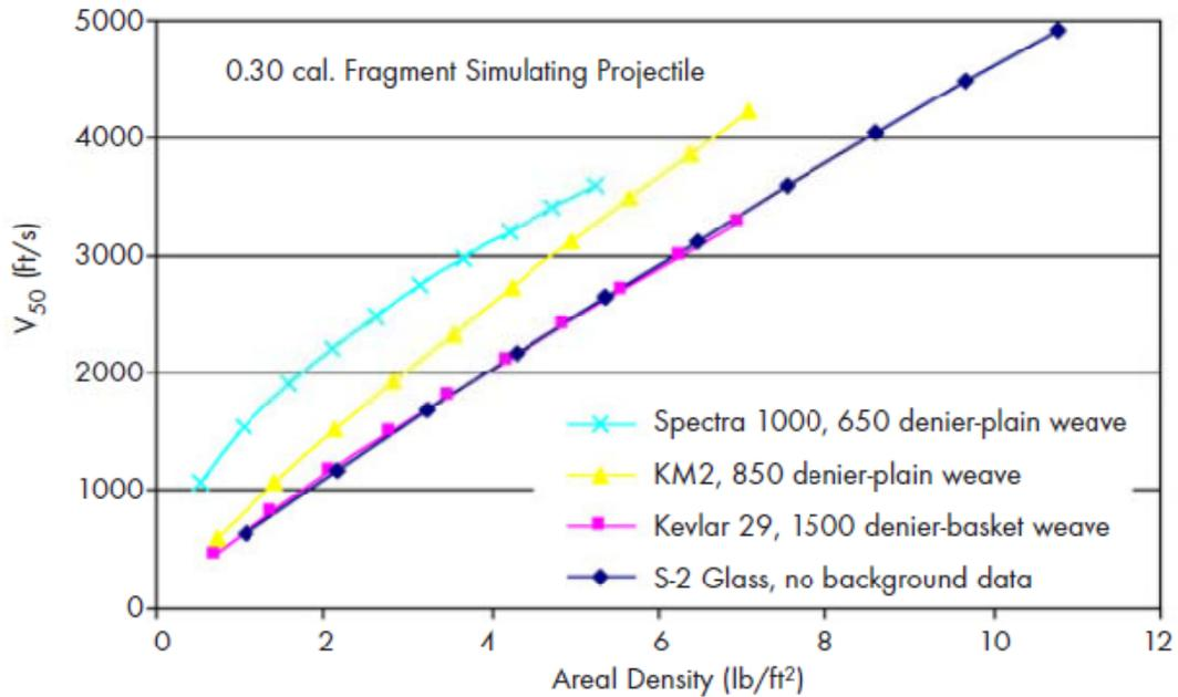
(a)  $V_{50}$  versus Areal DensitySlika 7.2 [12] Rezultati  $V_{50}$  testa s obzirom na gustoću za različite vrste kompozita
