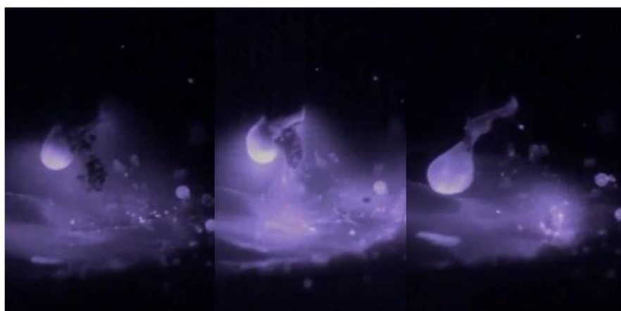
Slika 10: Prikaz prijenosa metala pulsirajućim lukom [8]
