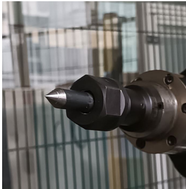
Slika 19. Šiljak stegnut u steznu čeljust motorvretena
