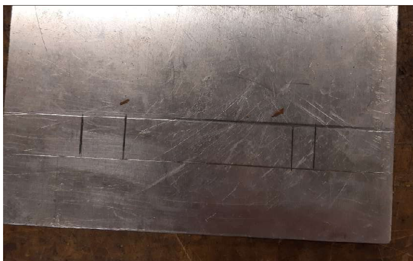
Slika 18. Pozicija uzoraka za analizu mikrostrukture
