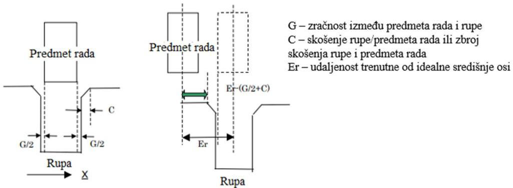
**Slika 4.34.** Greška pozicioniranja za funkciju *Shaft Insert* [20]
