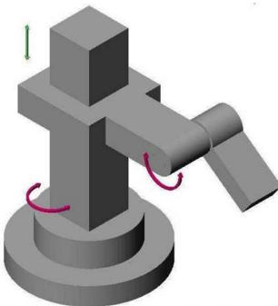
**Slika 2.3.** Kvazicilindrična struktura robota
