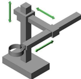
**Slika 2.1.** Kartezijska struktura robota
