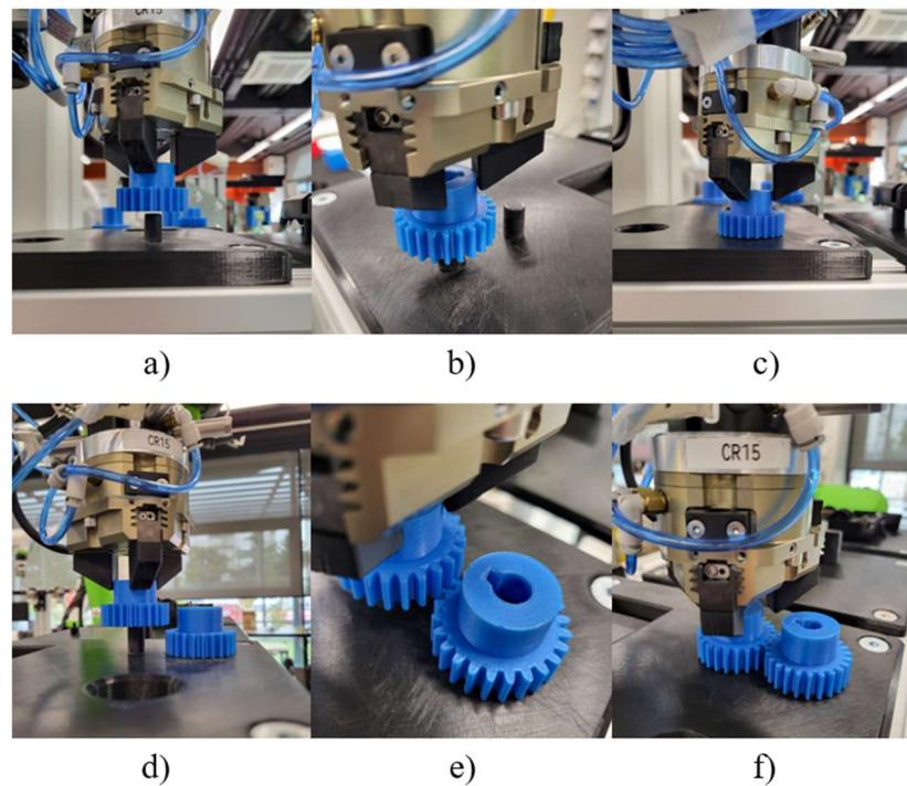
**Slika 4.54.** Izvođenje funkcije: a) prilazna točka zupčanika s utorom za pero, b) izvršavanje funkcije usklađivanja, c) izvršena funkcija umetanja, d) pozicija drugog zupčanika, e) izvršavanje funkcije usklađivanja, f) izvršena funkcija umetanja
