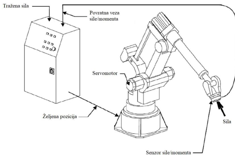
**Slika 3.1.** Način rada sustava senzora sile/momenta [14]
