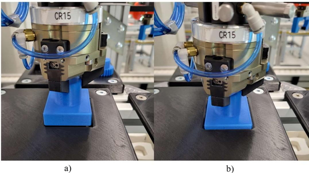
Slika 4.41. Izvođenje funkcije: a) prilazna točka uz pozicijsku grešku, b) izvršena funkcija
