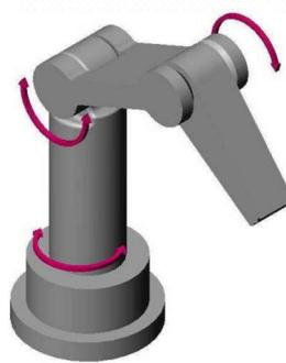
**Slika 2.5.** Rotacijska struktura robota
