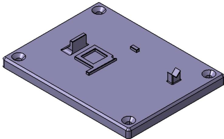
**Slika 4.9.** CAD model palete za pohranu kućišta ekstrudera
