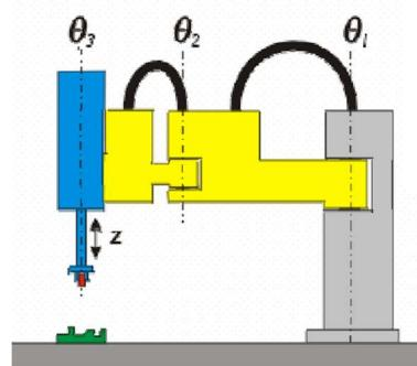
**Slika 2.6.** SCARA struktura robota
