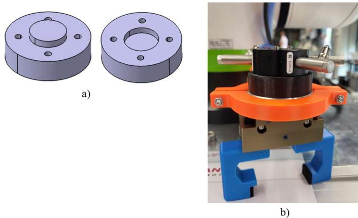
Slika 4.14. Adapterska ploča: a) CAD model, b) implementacija
