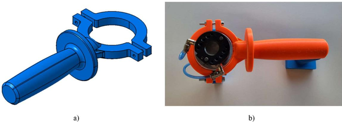
**Slika 4.5.** a) CAD model ergonomske ručke, b) printana montirana ručka
