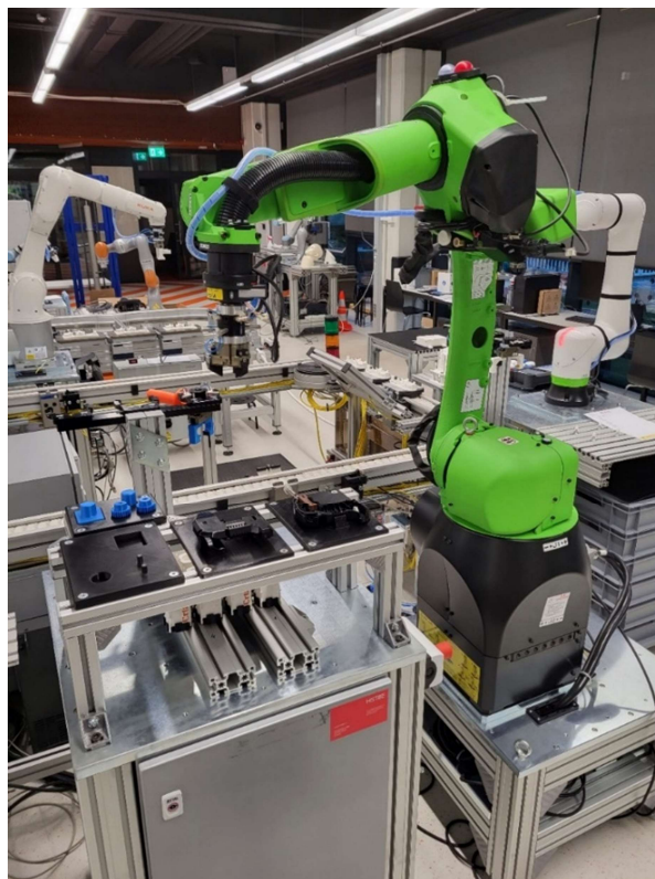
Slika 4.11. Realiziran postav s montiranim paletama
