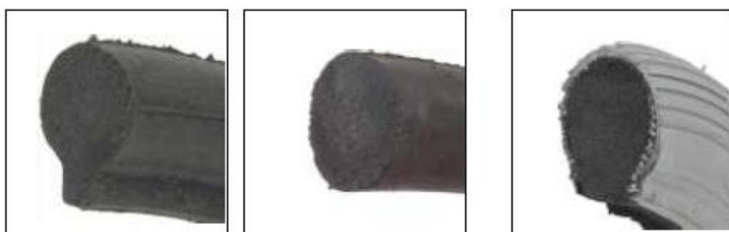
Slika 43. Tvrda ispuna za kotač invalidskih kolica [17]
