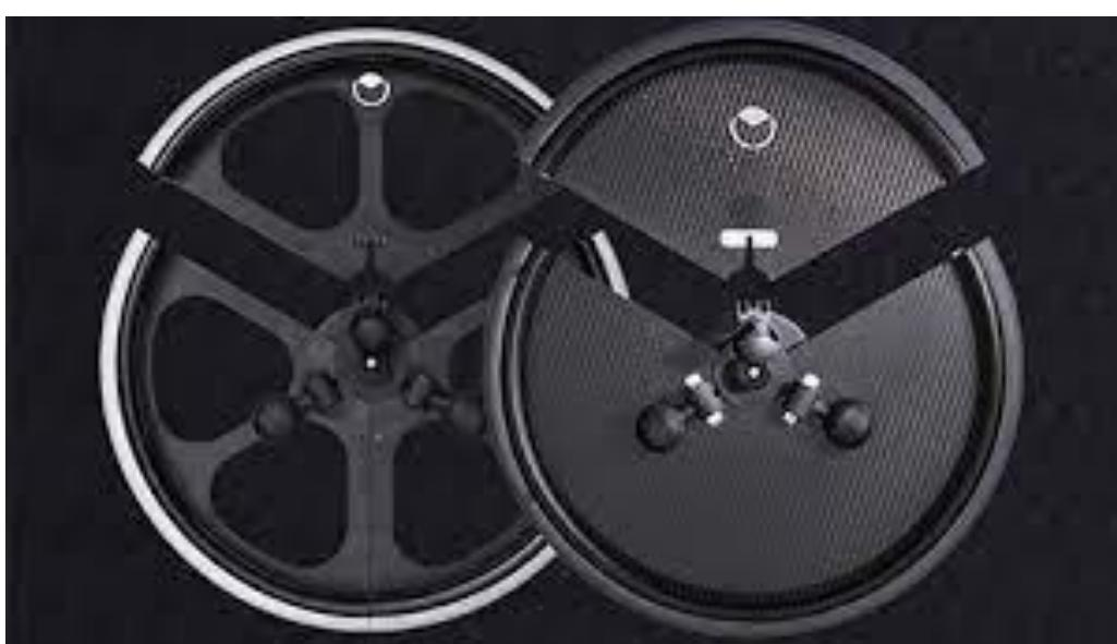
Slika 21. Trivida kotač, plastični (lijevo), karbonska vlakna (desno) [14]
