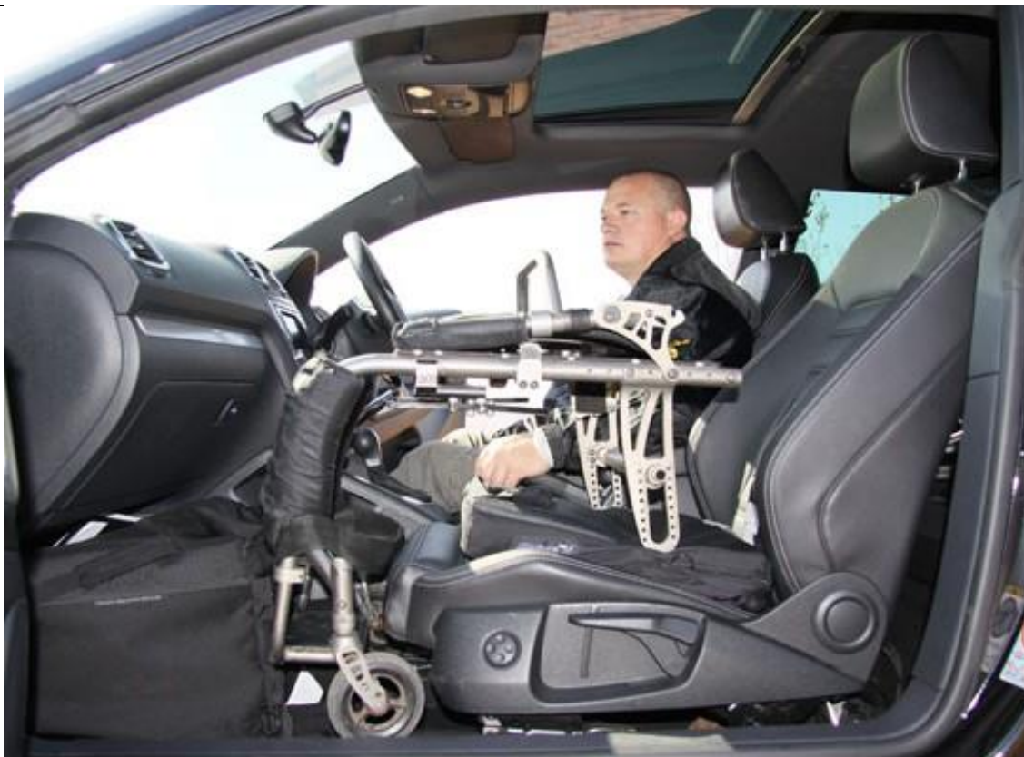
Slika 11. Smještanje okvira na prednje sjedalo [5]
