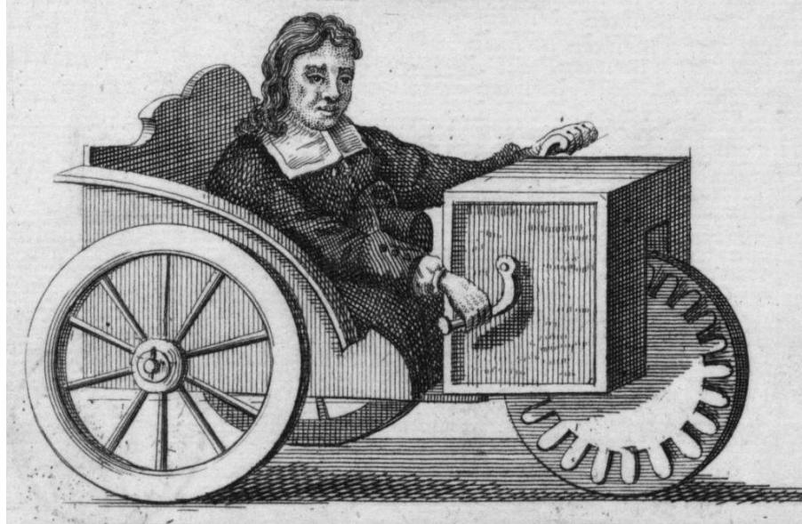
Slika 1. Faflerova invalidska kolica na ručni pogon [1]
