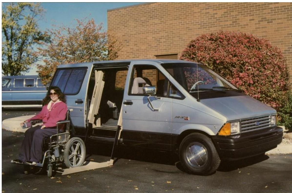
Slika 4. Ford monovolumen s rampom za invalidska kolica [1]
