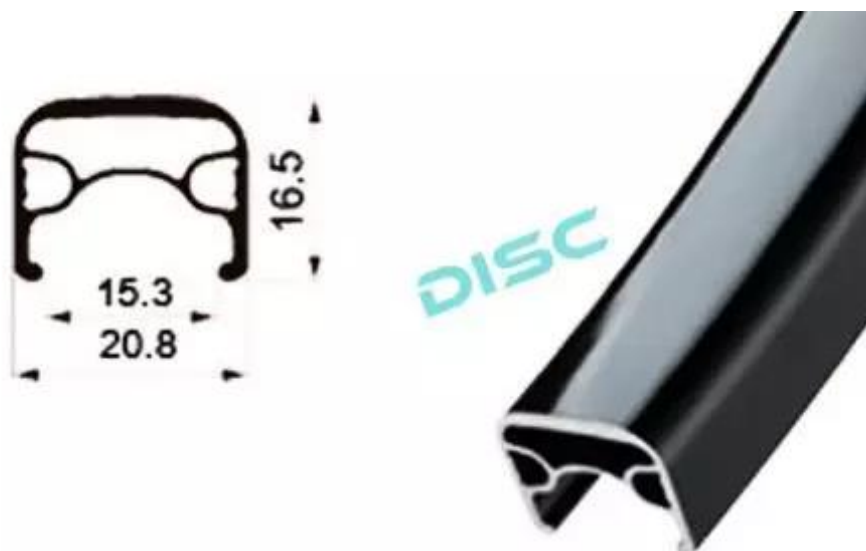
Slika 41. Odabrani profil za obruč kotača [22]
