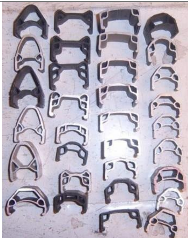
Slika 40. Različiti profili za obruč kotača [21]
