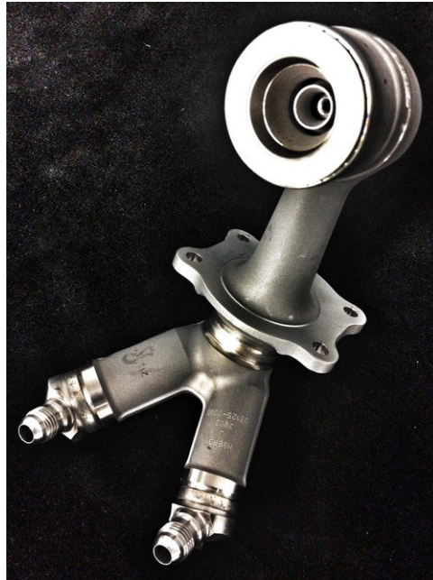
Slika 2.3. Mlaznica za gorivo na motoru GE9X Boeinga 777X [6]
