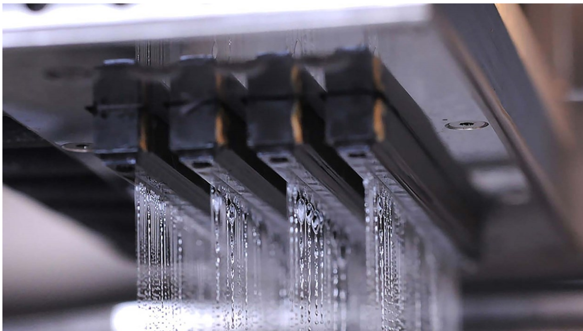
Slika 2.6. Glava MBJ stroja s mlaznicama [14]
