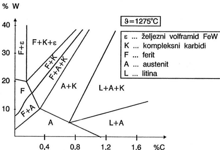
**Slika 2.2. Izotermički presjek Fe-W-C sustava brzoreznog čelika [1]**
