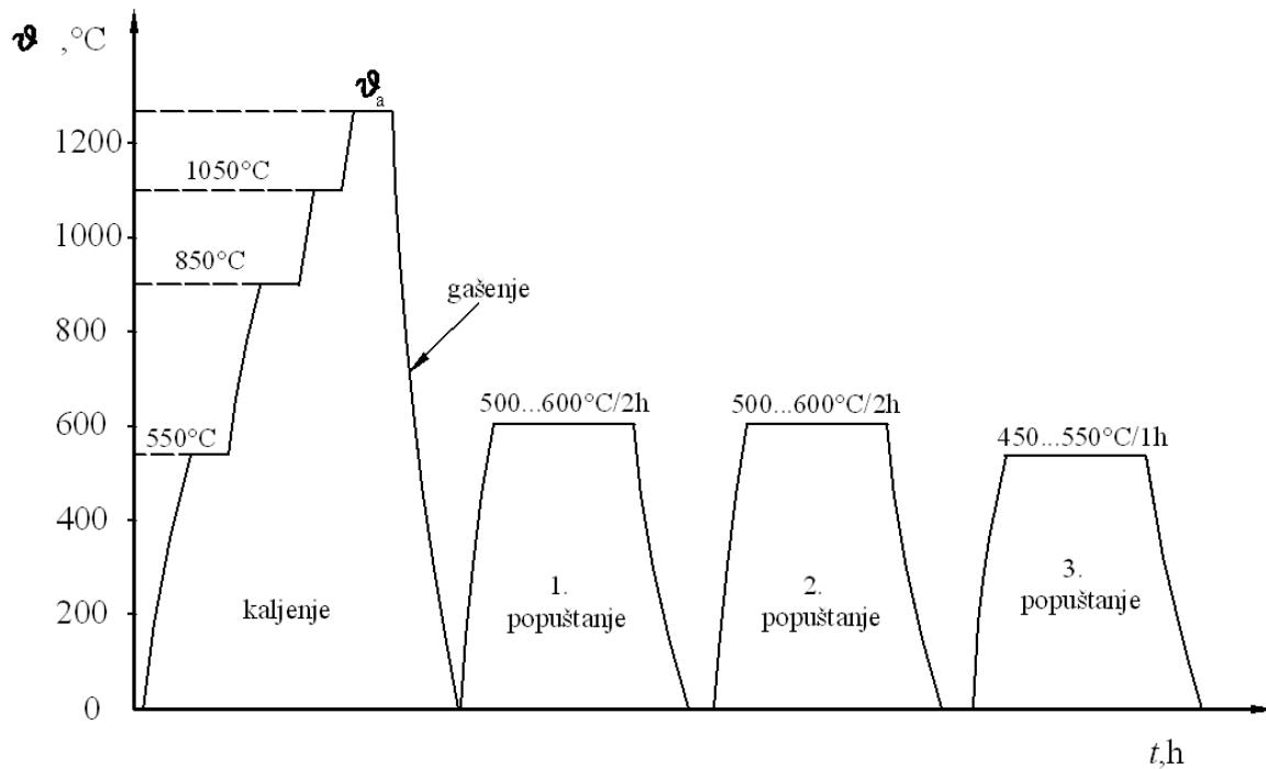
**Slika 2.9.** Dijagram postupka kaljenja i popuštanja brzoreznog čelika [1]
