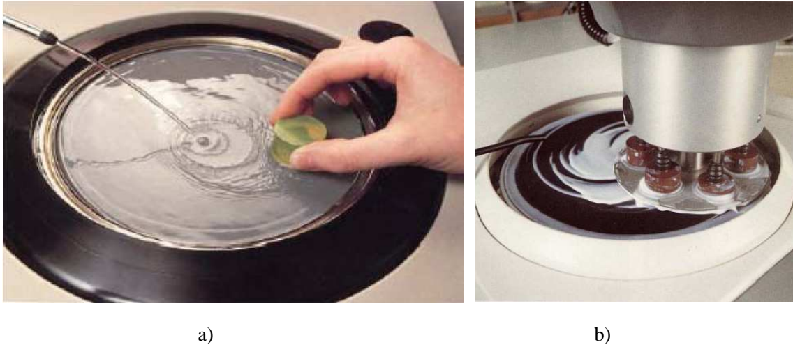
Slika 4.6. Poliranje uzorka na brusnom papiru (a) i strojno poliranje više uzoraka odjednom [15]
