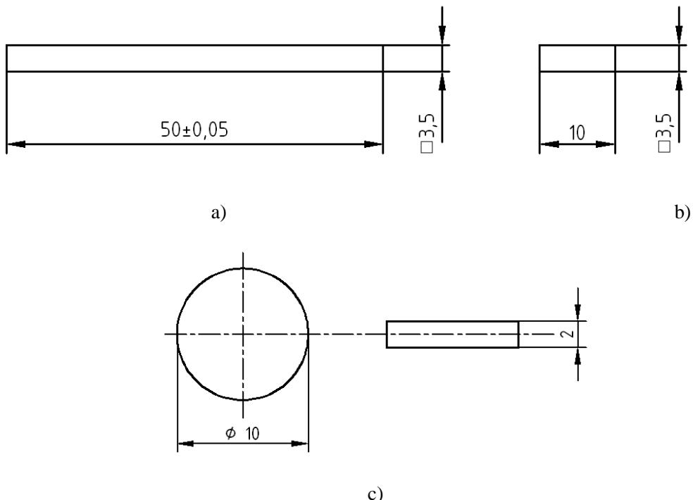
**Slika 4.1.** Dimenzije uzorka a) za dilatometriju, b) za metalografiju, c) za rendgensku difrakciju
