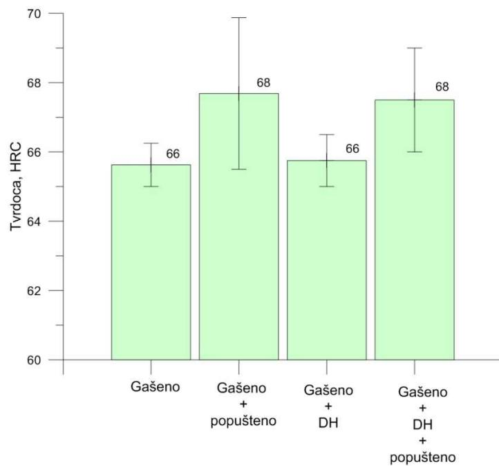
**Slika 5.6.** Tvrdoće uzoraka temperature austenitizacije  $1230^{\circ}\text{C}$
