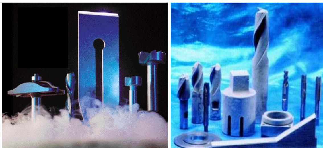
Slika 3.7. Alati podvrgnuti postupku dobokog ohlađivanja [5]
