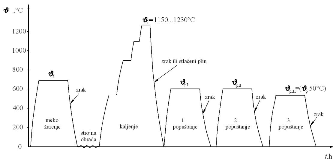
**Slika 2.18. Dijagram toplinske obrade čelika Böhler S390 Microclean®**
