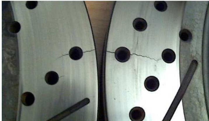
Slika 3.8. Usporedba pukotina nastalih na tvornički obrađenom disku (desno) i naknadno tretiranog postupkom dubokog hlađenja (lijevo) [21]
