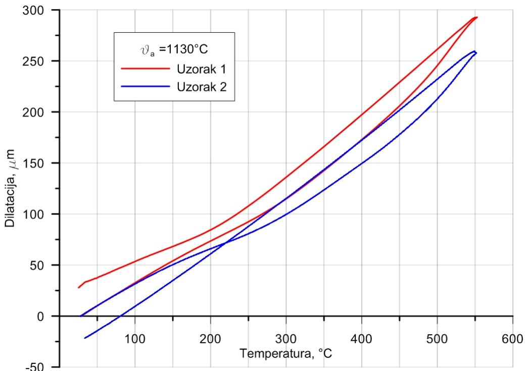
**Slika 5.9.** Dilatogrami ispitnih uzoraka 1 i 2 izrađenih od Böhler S390 Microclean® čelika nakon kaljenja sa temperature austenitizacije  $1130^{\circ}\text{C}$  ( $N_2$ ) i:
