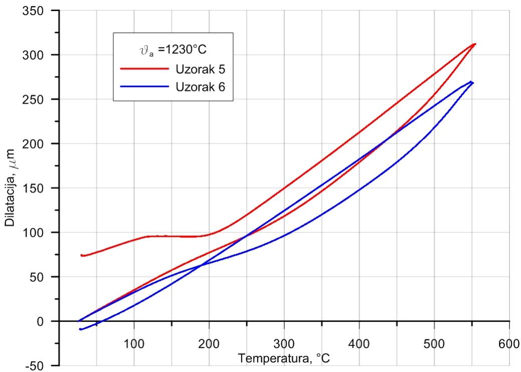
**Slika 5.11.** Dilatogrami ispitnih uzoraka 5 i 6 izrađenih od Böhler S390 Microclean<sup>®</sup> čelika nakon kaljenja sa temperature austenitizacije  $1230^{\circ}\text{C}$  ( $N_2$ ) i:
