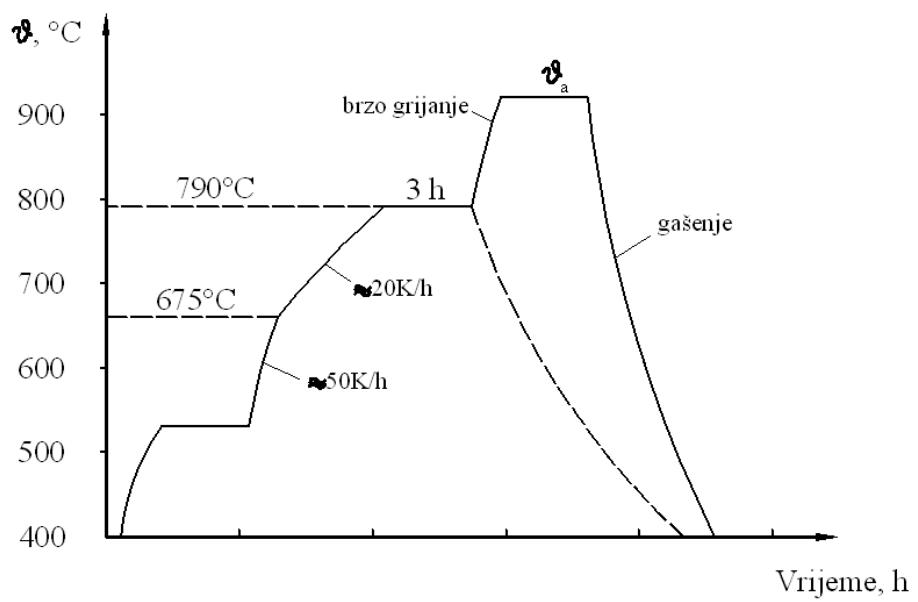
**Slika 2.4.** Dijagram raskaljivanja postupka brzoreznih čelika po Gill-u [1]
