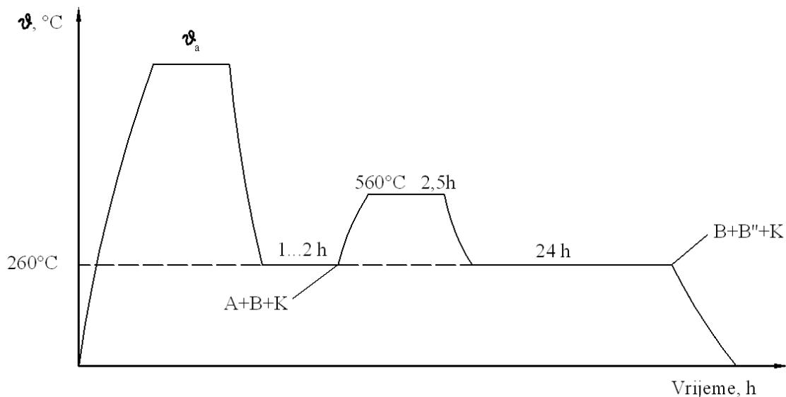
**Slika 2.11.** Dijagram postupka bainitne obrade brzoreznog čelika [1]
