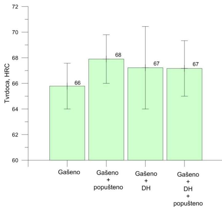
**Slika 5.5.** Tvrdoće uzoraka temperature austenitizacije  $1180^{\circ}\text{C}$
