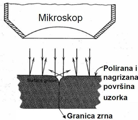
**Slika 4.7.** Shematski prikaz utjecaja kemijskog nagrizanja uzorka na mikroskopiranje [16]
