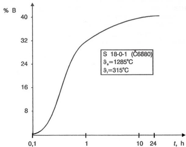
**Slika 2.10.** Krivulja izotermičke pretvorbe u bainit pri  $315^{\circ}\text{C}$  [1]
