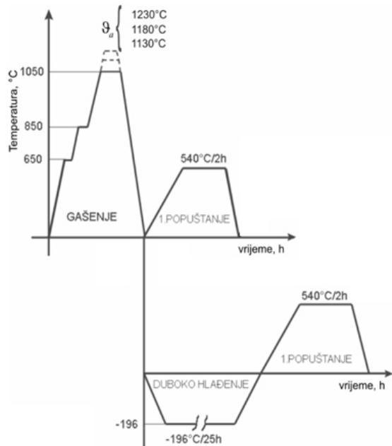
**Slika 4.4. Shematski prikaz toplinske obrade uzorka**
