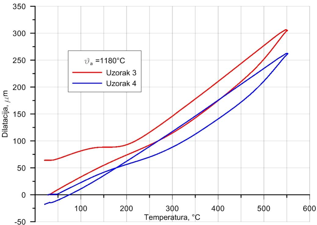
**Slika 5.10.** Dilatogramu ispitnih uzoraka 3 i 4 izrađenih od Böhler S390 Microclean® čelika nakon kaljenja sa temperature austenitizacije  $1180^{\circ}\text{C}$  ( $\text{N}_2$ ) i:
