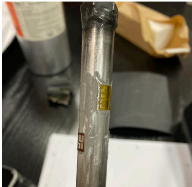
**Slika 4.12. Strojni dio sa postavljenim tenzometrima i terminalima**
