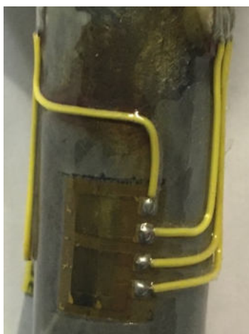
Slika 4.13. Izrada ožičenja između tenzometara i terminala
