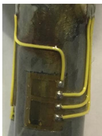
**Slika 4.13. Izrada ožičenja između tenzometara i terminala**
