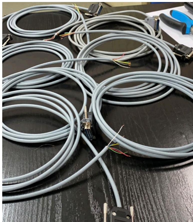
Slika 4.15. Priključni šesterožilni kablovi
