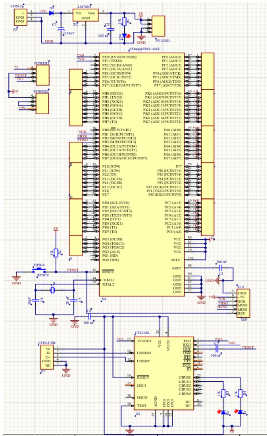
Slika 7. Shematski prikaz Arduino Mega 2560 razvojne platforme
