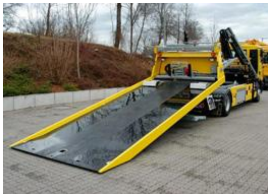
Slika 34. Čelična konstrukcija platforme na vozilu N2 kategorije [10]
