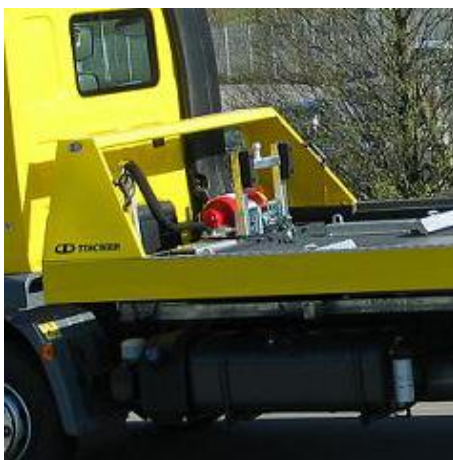
Slika 7. Pozicija ugradnje vitla [6]
