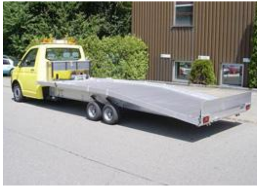
Slika 33. Aluminijska konstrukcija platforme na vozilu N1 kategorije [10]
