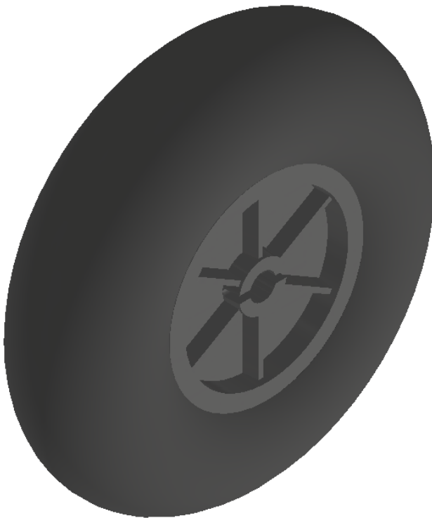
Slika 18. Procjena inercije kotača pomoću CAD alata
