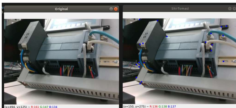
Slika 9. Primjer otkrivenih kutova Shi-Tomas algoritmom
