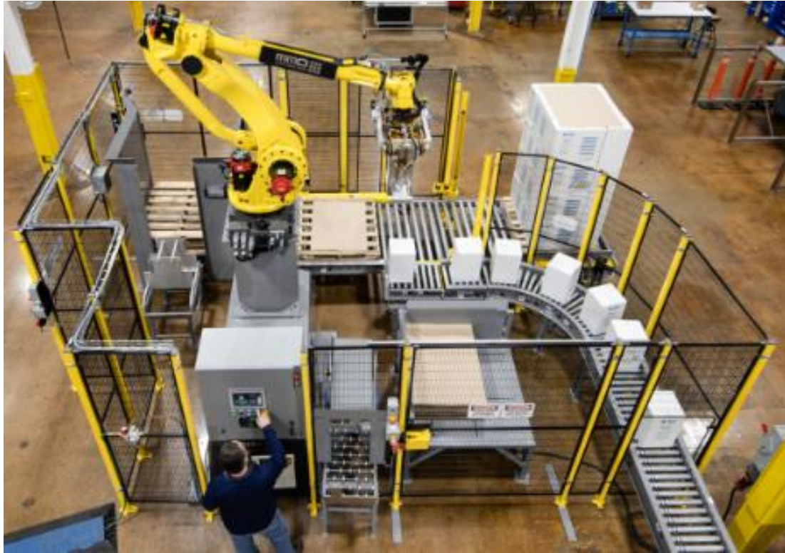
Slika 3. Automatiziran proces paletizacije
