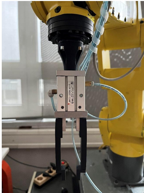
Slika 15. Gotov model nastavka za hvataljku
