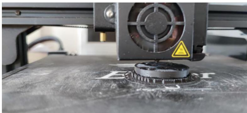
Slika 12. Početak ispisa držača hvataljke
