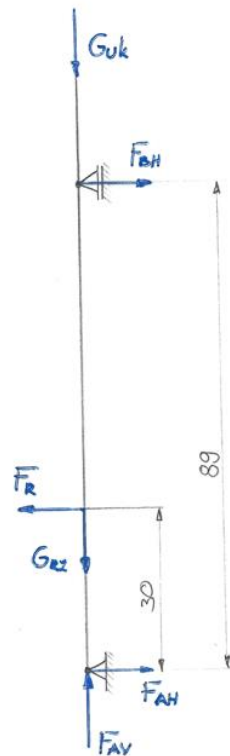
Slika 16 Proračunski model vratila
