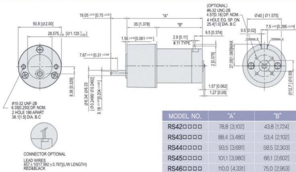
Slika 38. Motor mehanizma za nagib
