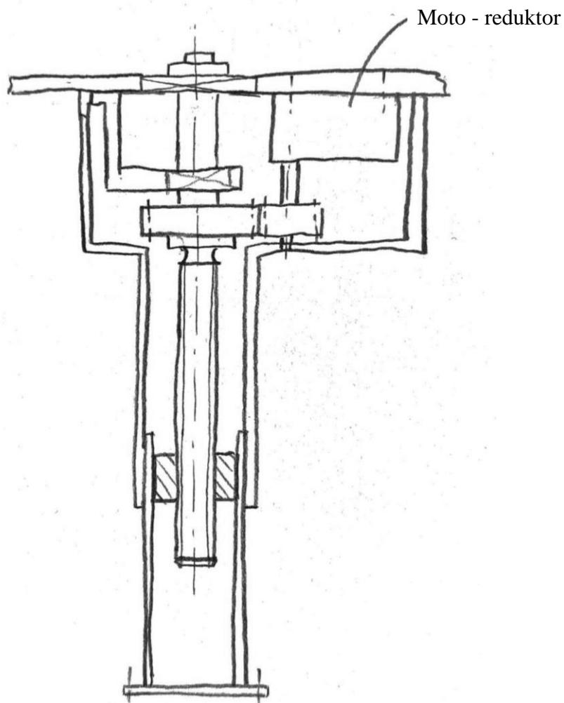
**Slika 16. Koncept 1 - mehanizam podizanja**
