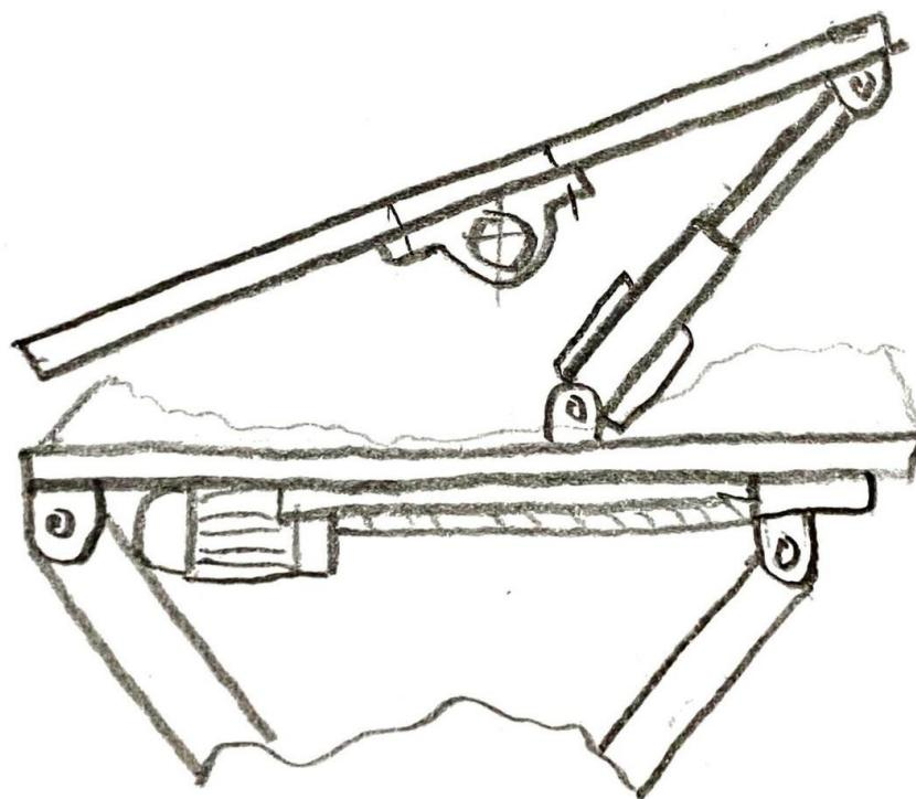
Slika 26. Mehanizam nagiba radne površine - koncept 3
