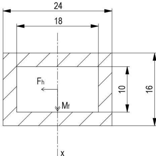
Slika 39. Presjek zavara i opterećenje zavara
