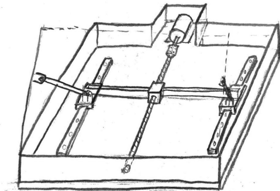
**Slika 17. Mehanizam promjene nagiba – Koncept 1**
