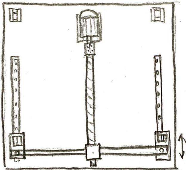
Slika 25. Mehanizam podizanja i spuštanja stola – koncept 3
