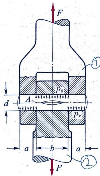
Slika 40. Shema zglobnog spoja svornjakom
