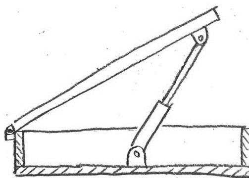
**Slika 31. Mehanizam promjene nagiba - koncept 4**
