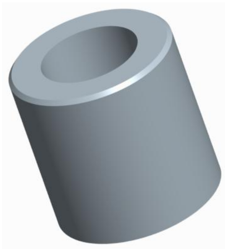
Crtež 11 .Priključak ventila za izuzimanje tekuće faze
