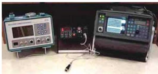
Slika 2: Oprema za EC ispitivanje [1]
