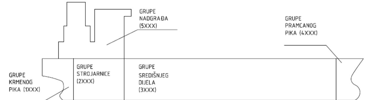
Slika 6. Uobičajena podjela broda na makroprostore po principu karakterističnih dijelova broda
