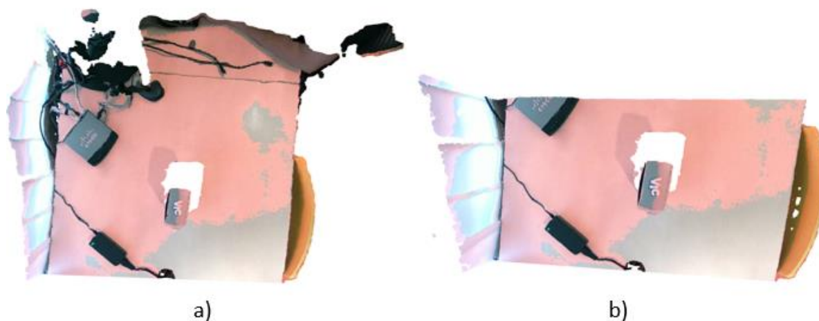
Slika 3.14 a) Oblak točaka prije Pass Through filtra, b) oblak točaka poslije filtra
