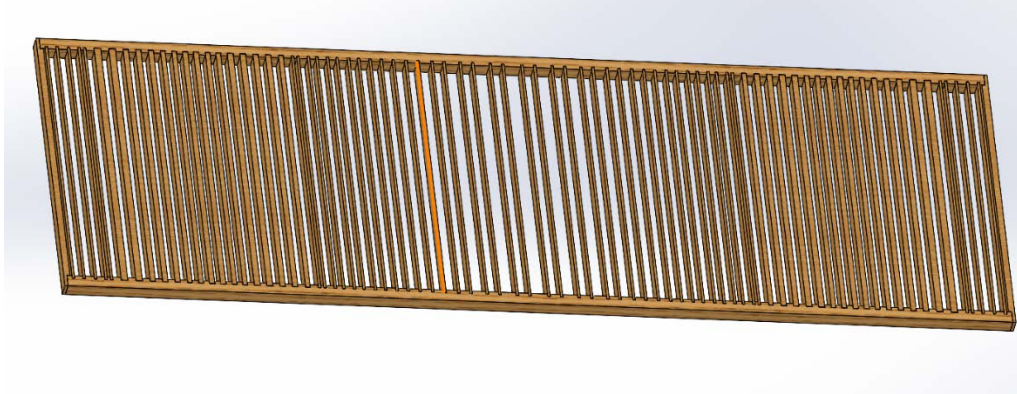
Slika 49. Izgled osnovice zračnice s tonskim kancelama.
