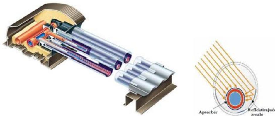
Slika 15. Osnovni dijelovi vakuumskog kolektora [4]
