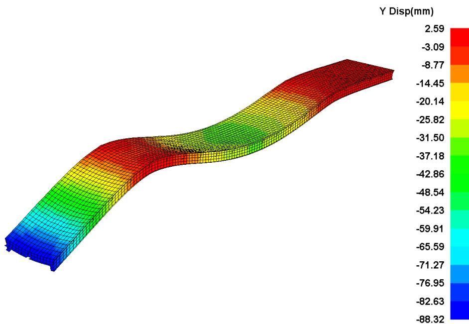
**Slika 23.** Pogibi prototipa varijante 1 za LC6
