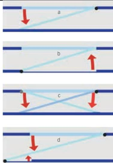
Slika 3. Shema pomicne pristupne rampe [8]
