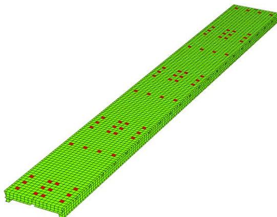
Slika 18. Zadano maseno opterećenje od otiska kotača za LC8
