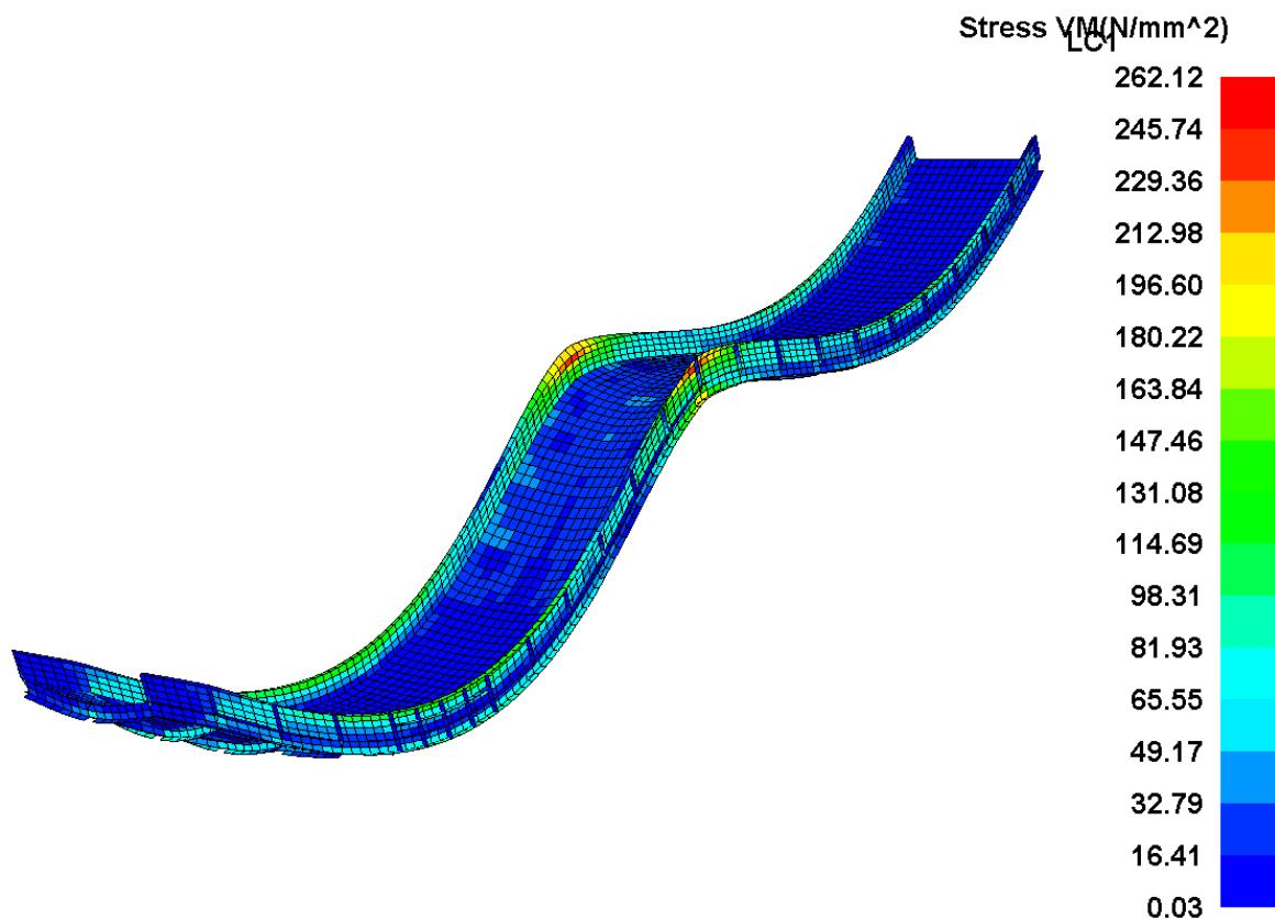
**Slika 27. Von Mises naprezanja prototipa varijante 2 za LC1**
