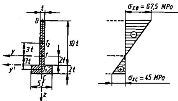
**Slika 9.8.** Raspored naprezanja zbog savijanja po visini nesimetričnog presjeka**Slika 33.** Raspored naprezanja zbog savijanja po visini nosača [11]
