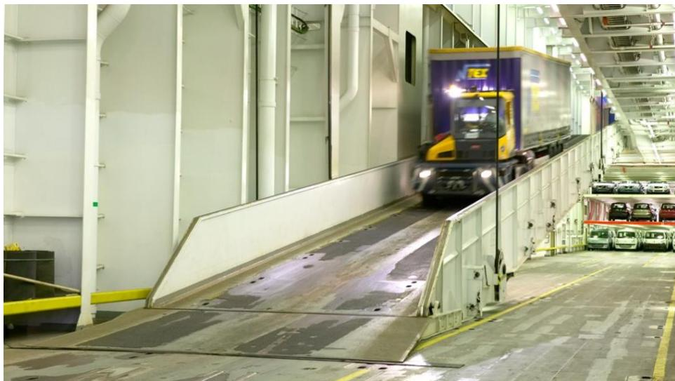
Slika 4. Primjer pomicne pristupne rampe [8]
