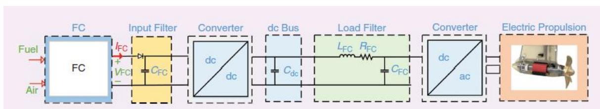
Slika 22. Konfiguracija tipičnog energetskog postrojenja s gorivnim člancima [31]
