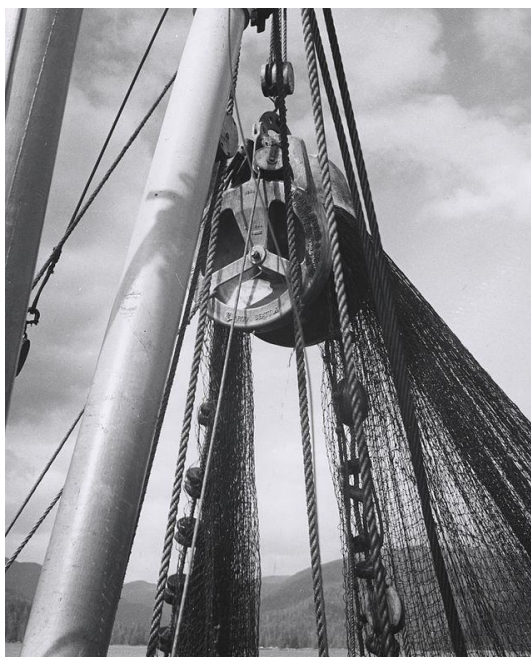
Slika 10. Puretćevo vitlo (eng. Puretic power block ) [17]
