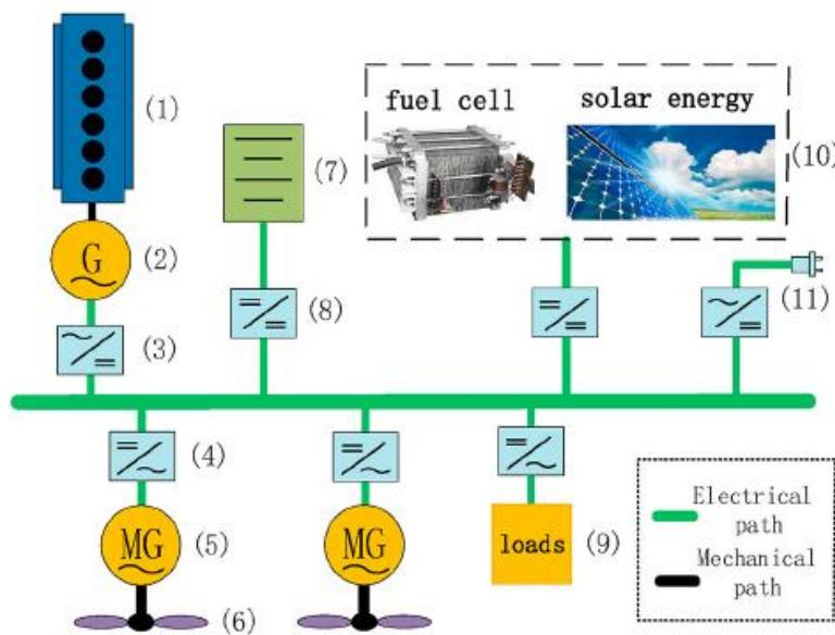
(1) Dizelski motor, (2) Generator, (3) AC/DC pretvarač, (4) DC/AC pretvarač, (5) Elektromotor, (6) Propulzor, (7) Uređaji za skladištenje energije, (8) DC/DC pretvarač, (9) Opskrba ostalih potrošača, (10) Gorivni članci i solarni paneli, (11) Energija s obale
