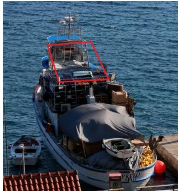
**Slika 37. Označena površina raspoloživa za ugradnju fotonaponskih čelija, slika preuzeta s [55] i uređena**
