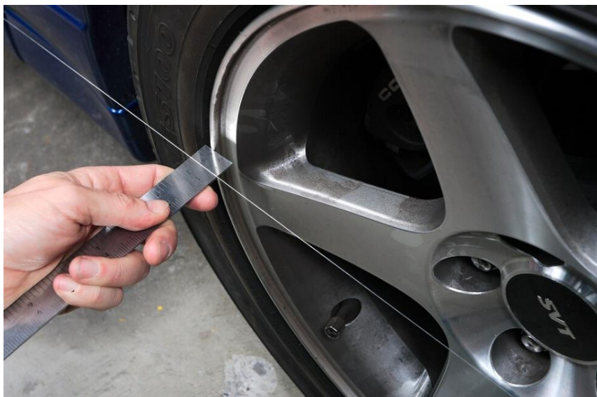
Slika 4.11. Udaljenost naplatka od mjerne sajle
