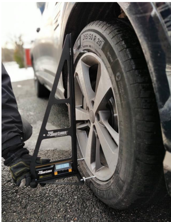
Slika 4.4. Primjena uređaja za mjerenje nagiba s inklinometrom
