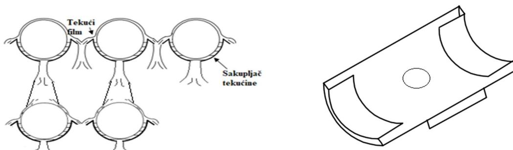
Slika 7. Prikaz tekućeg padajućeg filma po cijevima (lijevo) i ploča smještenih ispod cijevi (desno) [8]
