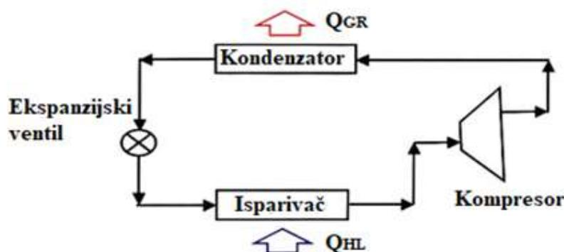
Slika 1. Shema lijevokretnog procesa s glavnim komponentama sustava
