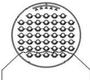
Slika 6. Shematski prikaz poprečnog presjeka naplavljenog škropnog isparivača [7]
