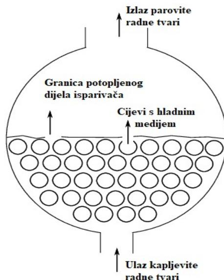
Slika 2. Shematski prikaz poprečnog presjeka naplavljenog isparivača [3]
