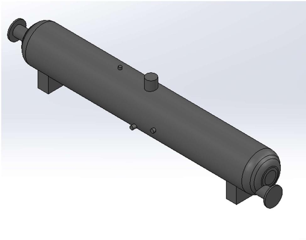
Slika 21. Shell and tube naplavljeni škropni isparivač
