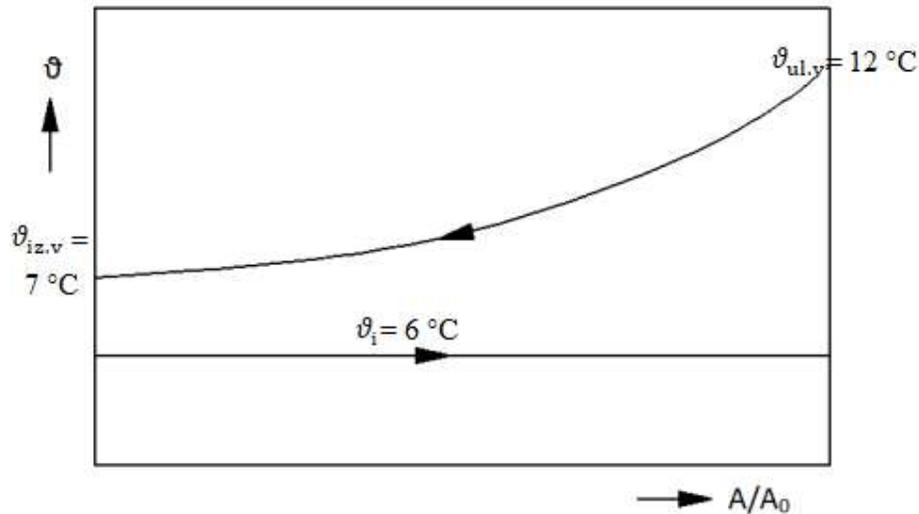
Slika 22. Ovisnost temperatura isparavanja i hlađene vode o površini isparivača
