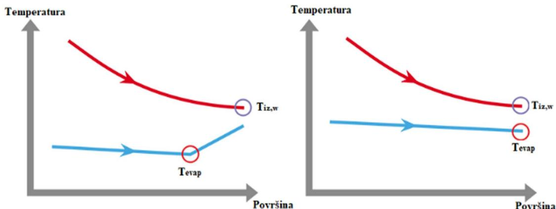
Slika 5. Temperaturni profil suhog tipa isparivača (lijevo) i naplavljenog tipa isparivača (desno) [5]
