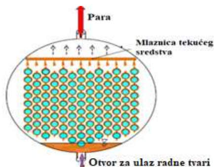
Slika 8. Pojednostavljen prikaz isparavanja radne tvari u škropnom isparivaču [9]
