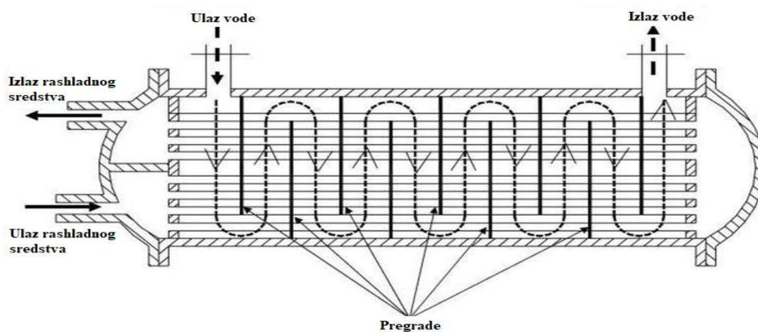
Slika 3. Shematski prikaz poprečnog presjeka suhog tipa isparivača [3]
