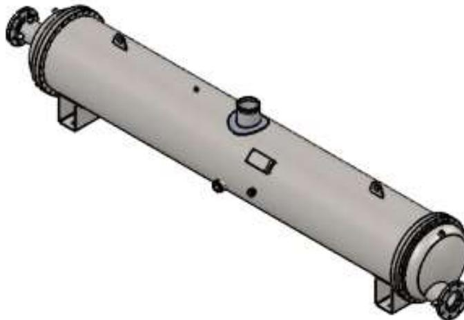
Slika 20. Odabran isparivač Provides ESWN.5031209-3P.M CSH
