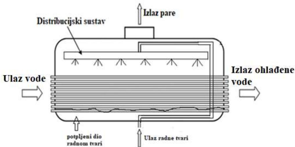
Slika 10. Pojednostavljen prikaz rada naplavljenog škropnog isparivača
