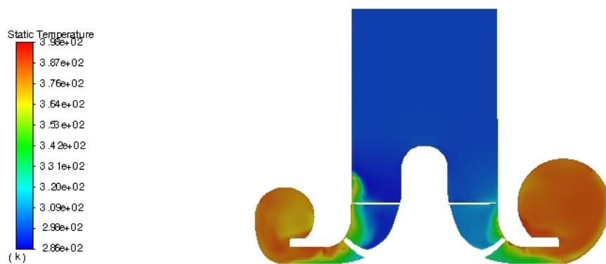
Slika 6.6: Konture temperature u meridionalnom presjeku
