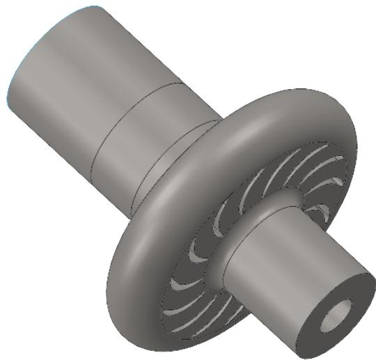
Slika 5.6: 3D model kompresora s prestrujnim kanalom
