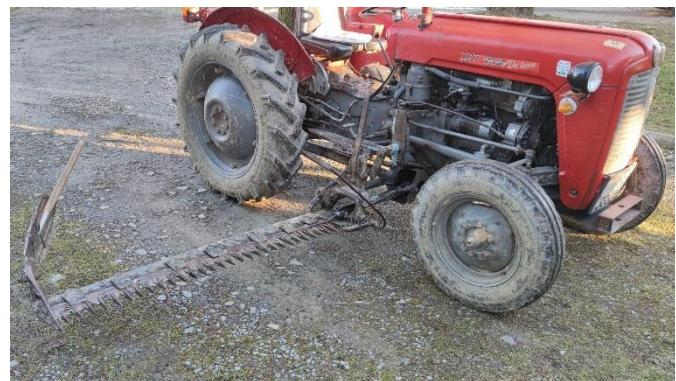
**Slika 6. Oscilirajuća bočna kosa montirana na traktor IMT 539**
