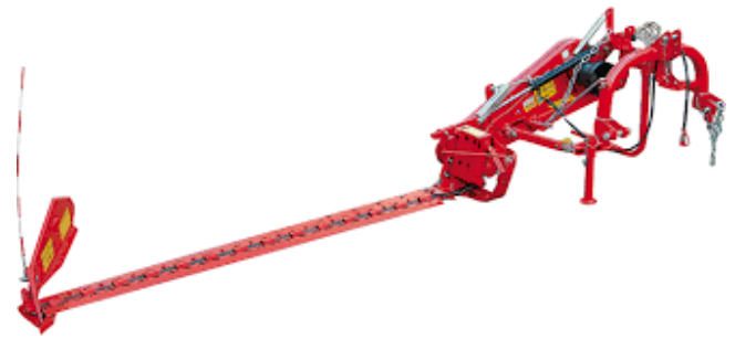
Slika 8. Oscilirajuća kosa s prstima Gaspardo montirana na trozglobnu hidrauličnu poteznicu [10]
