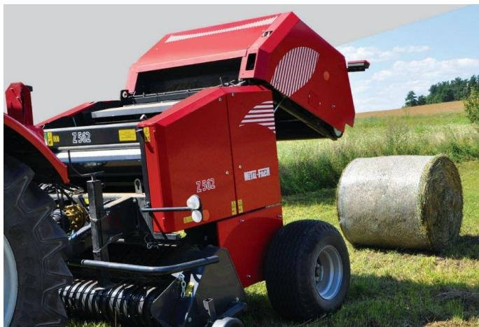
**Slika 22.** Preša za valjkaste bale proizvođača Metal Fach [16]
