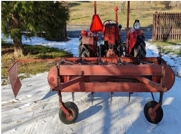
Slika 17. Okretač s beskrajnou trakom s elastičnim zupcima (prstima)
