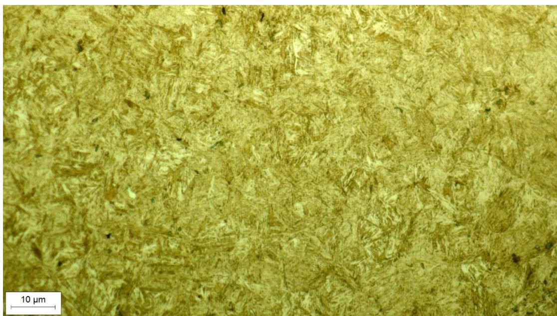
**Slika 53. Mikrostruktura na rubu zuba-500x povećanje**
