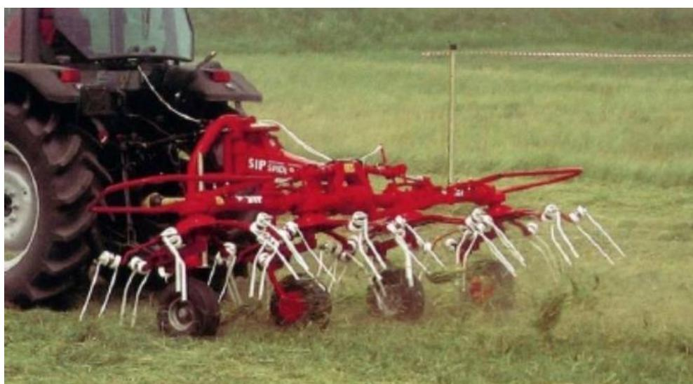
**Slika 13. Rotacijski okretač-rastresač proizvođača SIP [7]**
