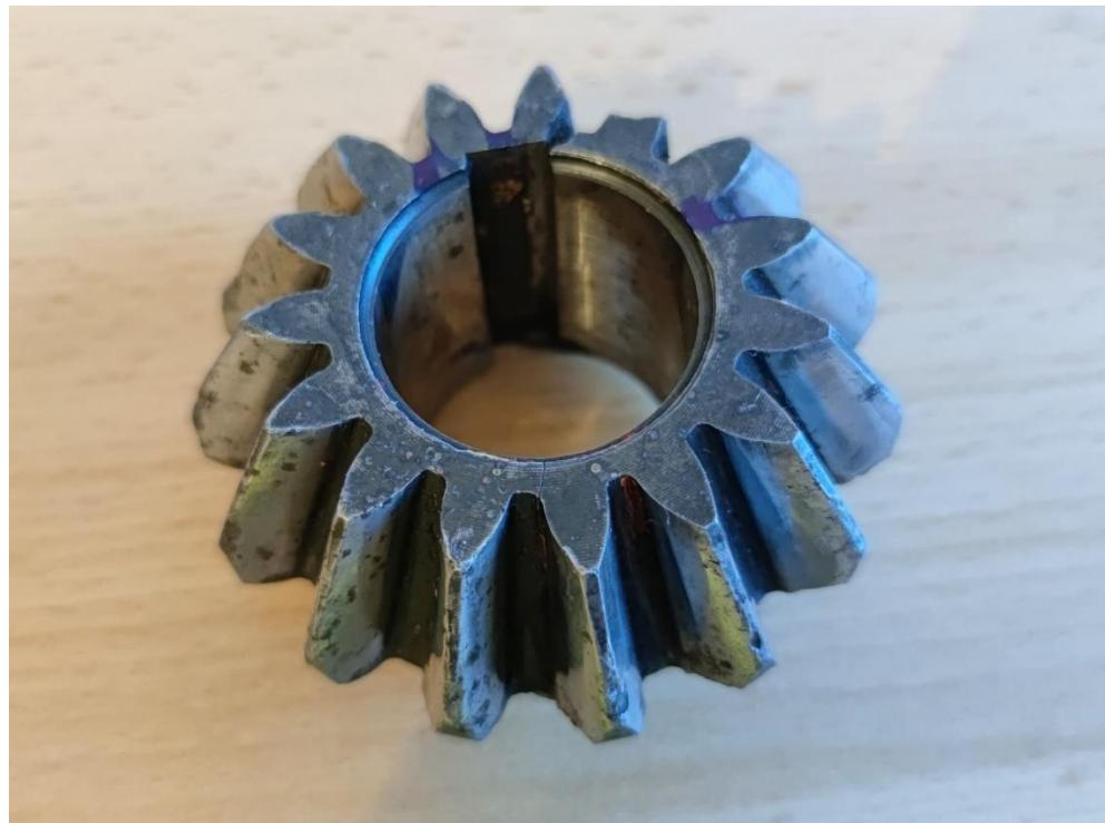
Slika 38. Tragovi trošenja (*pitting*) na cijelom obodu stožnika
