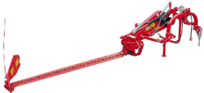
**Slika 8. Oscilirajuća kosa s prstima Gaspardo montirana na trozglobnu hidrauličnu poteznici [10]**
