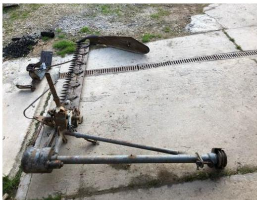
**Slika 5. Oscilirajuća bočna kosa za traktor IMT 539 [9]**
