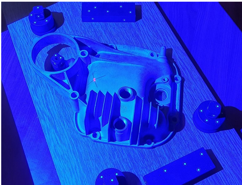
Slika 30. Postavljanje referentnih točaka oko predmeta
