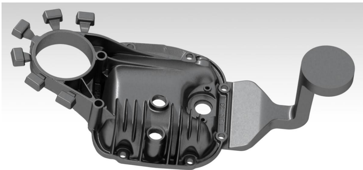
Slika 48. Renderirani CAD model sa sustavom za ulijevanje
