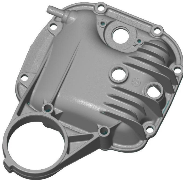
Slika 37. Spojeni model dobiven 3D skeniranjem – prednja strana
