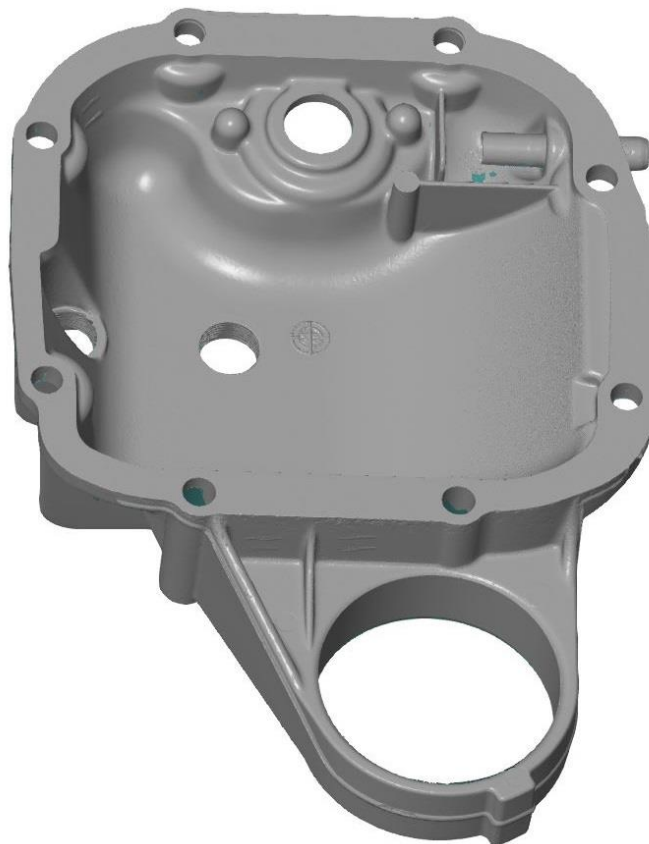
Slika 38. Spojeni model dobiven 3D skeniranjem – stražnja strana
