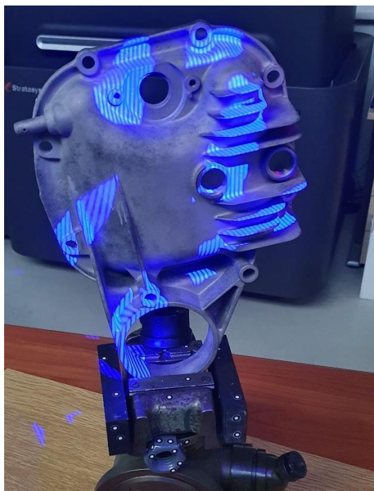
Slika 39. Parcijalno skeniranje površine
