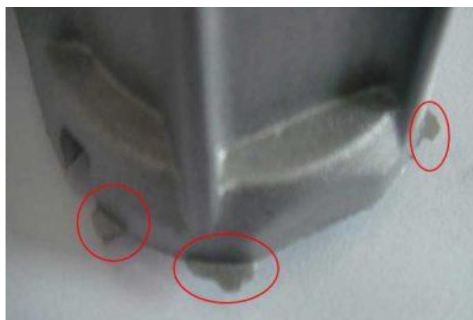
Slika 17. Rubni srhovi kod odljevka [13]
