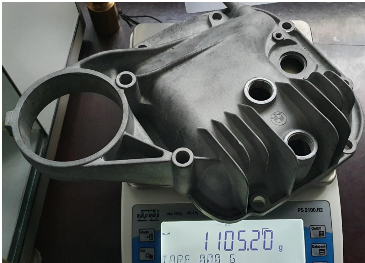
Slika 50. Izmjerena stvarna masa poklopca s oduškom
