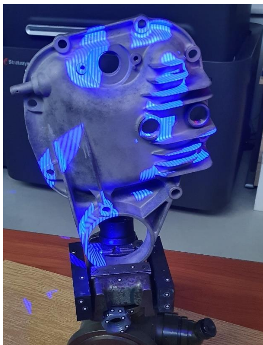
Slika 39. Parcijalno skeniranje površine
