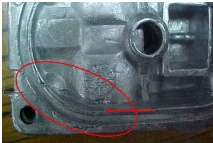
Slika 16. Nedostatak materijala u odljevku, nepotpun dio [13]
