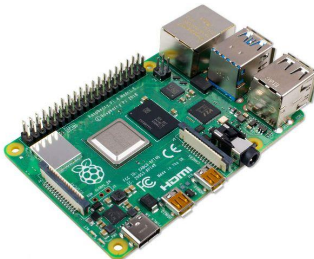
Slika 26. Mikroračunalo Raspberry pi 4. model B
