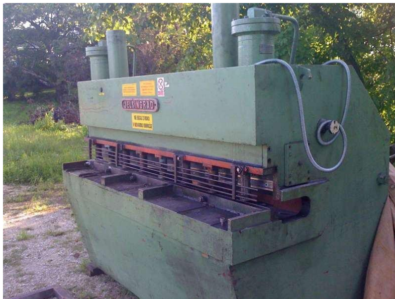
Slika 8. Hidrauličke škare za rezanje lima do debljine 5 mm
