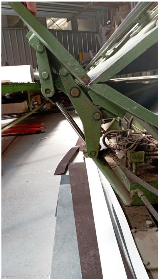
**Slika 13. Zglobno-polužni mehanizam hidrauličke savijačice**
