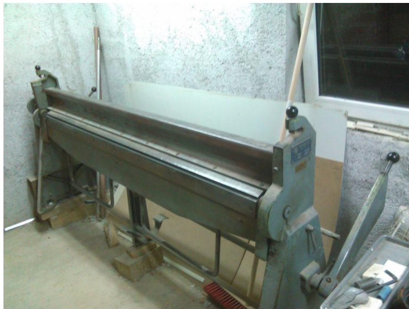
Slika 11. Savijačica lima ručna 2m
