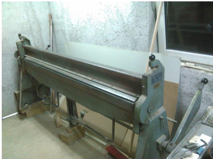
**Slika 11. Savijačica lima ručna 2m**
