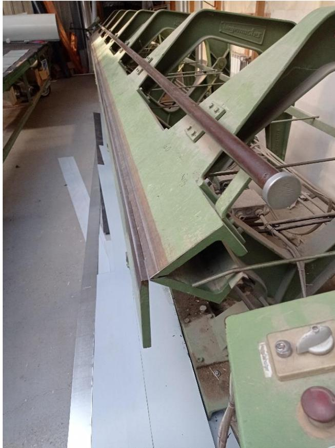
**Slika 12. Savijačica lima hidraulička 8.50 m**
