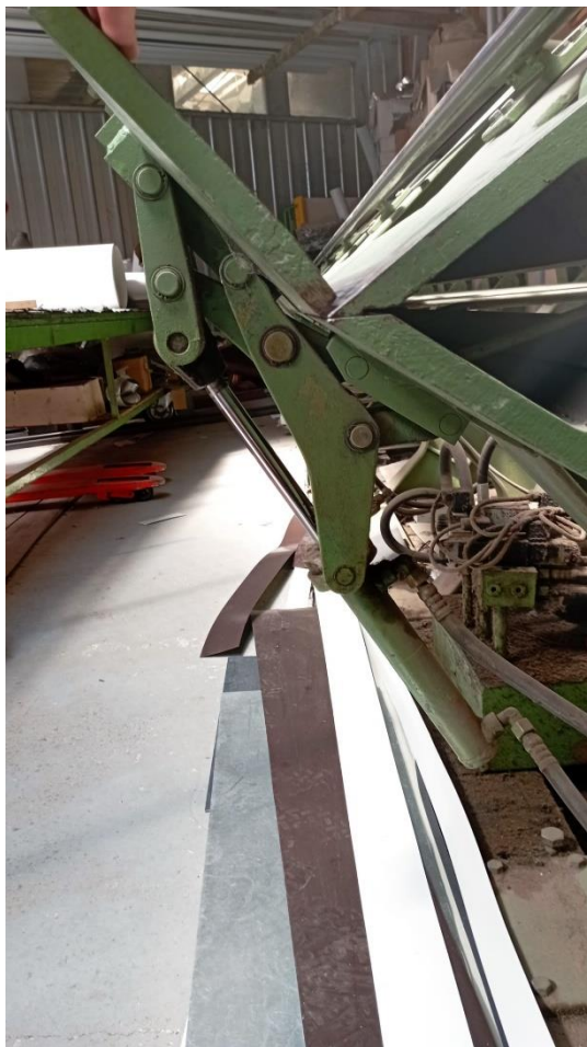
Slika 13. Zglobno-polužni mehanizam hidrauličke savijačice
