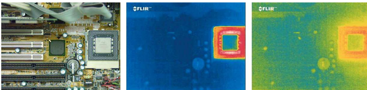
Slika 29. tiskana pločica snimana infracrvenom kamerom
