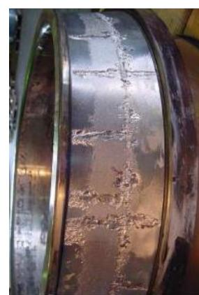
Slika 10. Oštećenja nastala tijekom rada ležaja [8]
