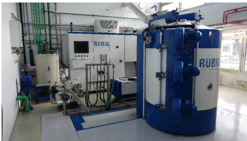
Slika 68. Uređaj PC 70/90 tvrtke Rübiger
