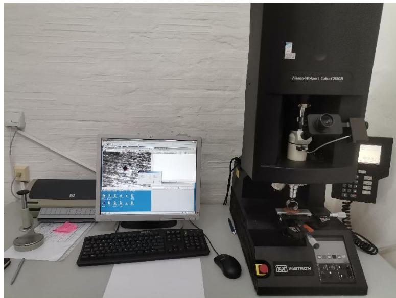
Slika 64. Uredaj za ispitivanje tvrdoće
