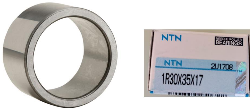
Slika 61. Nemodificirani EN DIN 100Cr6 prsten
