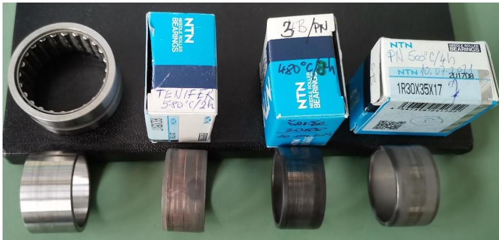
Slika 74. Prstenovi nakon provedbe ispitivanja bez podmazivanja
