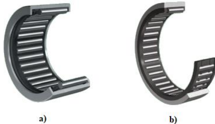
Slika 6. Vanjski prsten a) Nerastavljivi sklop proizveden dubokim vučenjem, b) Rastavljivi sklop proizveden postupcima odvajanjem čestica [6]
