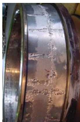
Slika 10. Oštećenja nastala tijekom rada ležaja [8]
