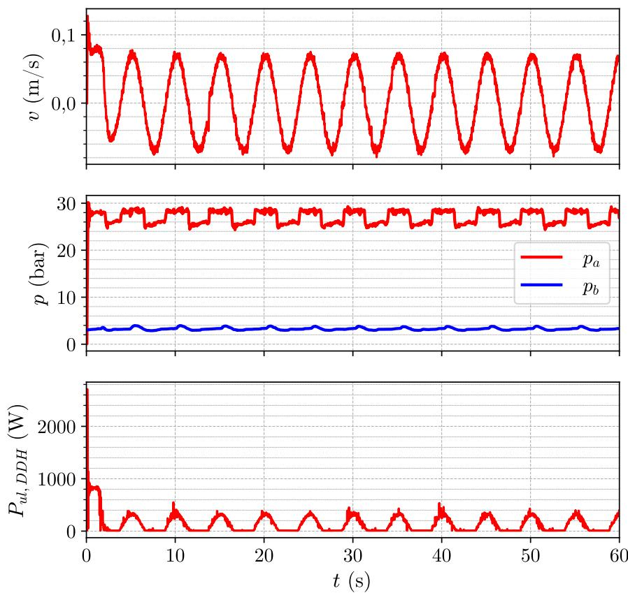
Slika 6.2: Primjer seta mjereni podataka DDH sustava za sinusnu pobudu i opterećenje od 200 kg
