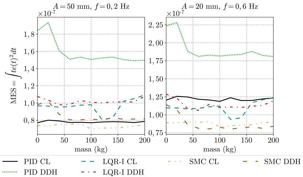
Slika 5.7: SMC regulator – kumulativna pogreška za sinusnu pobudu
