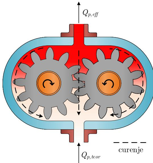
Slika 3.5: Shematski prikaz zupčaste pumpe s vanjskim ozubljenjem
