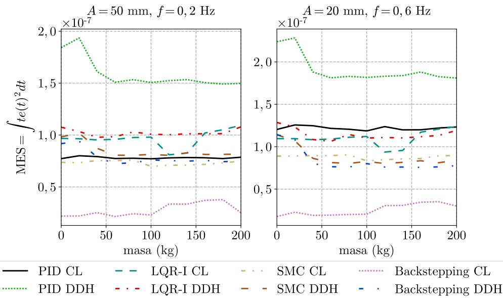
Slika 5.14: Backstepping regulator – kumulativna pogreška za sinusnu pobudu
