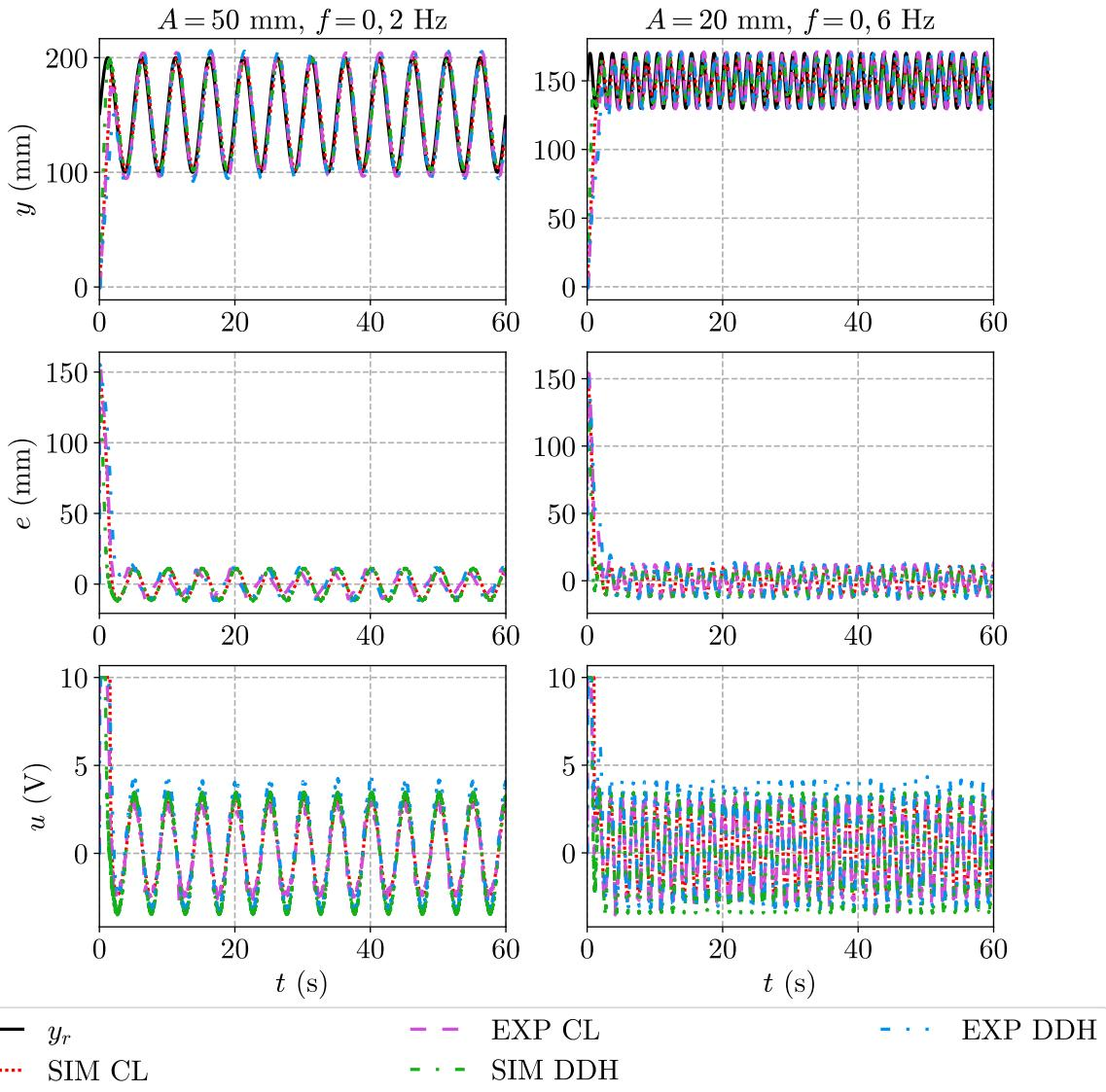
Slika 4.3: PID regulator – usporedba simulacijskih i eksperimentalnih rezultata za sinusnu pobudu
