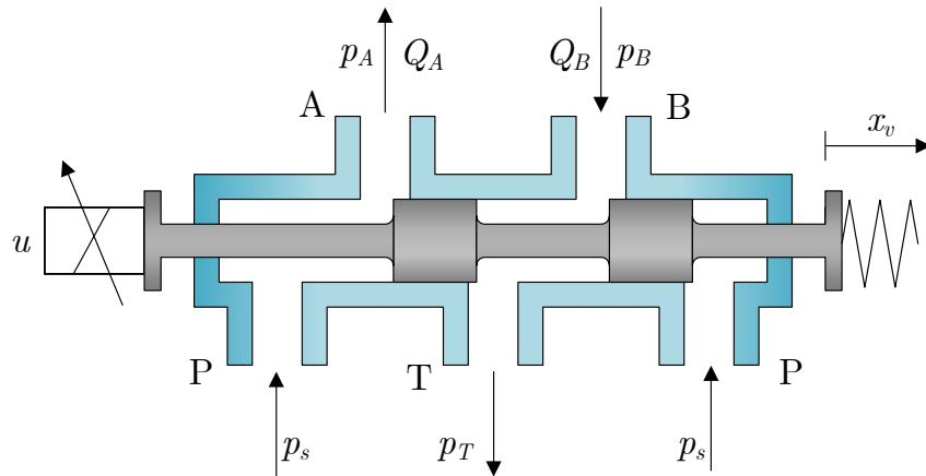
Slika 3.4: Shematski prikaz proporcionalnog hidrauličkog 4/3 ventila
