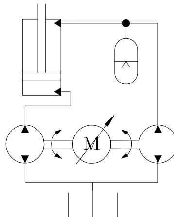
Slika 1.2: Pojednostavljeni shematski prikaz DDH sustava prema [40]
