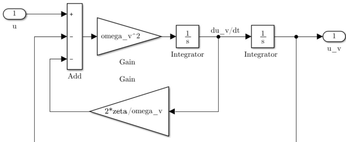
Slika B.9: Simulacijski model klipa 4/3 proporcionalnog ventila
