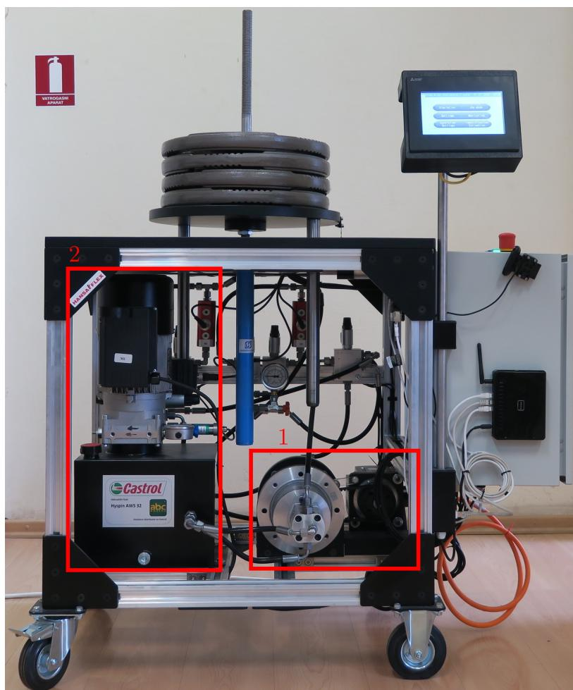
Slika 2.1: Eksperimentalni postav: (1) izravno pogonjeni sustav, (2) klasični sustav
