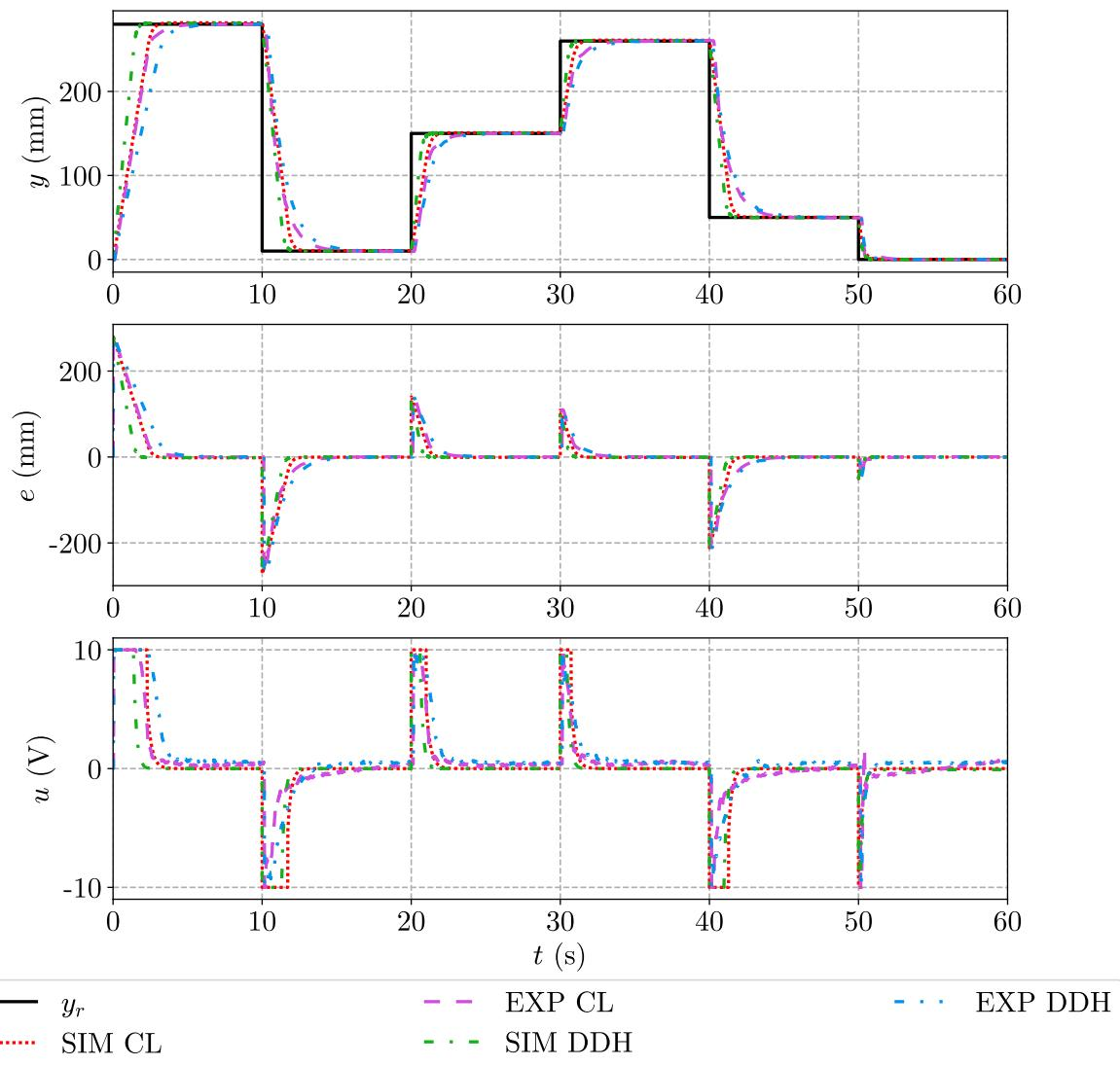
Slika 4.4: PID regulator – usporedba simulacijskih i eksperimentalnih rezultata za skokovitu pobudu
