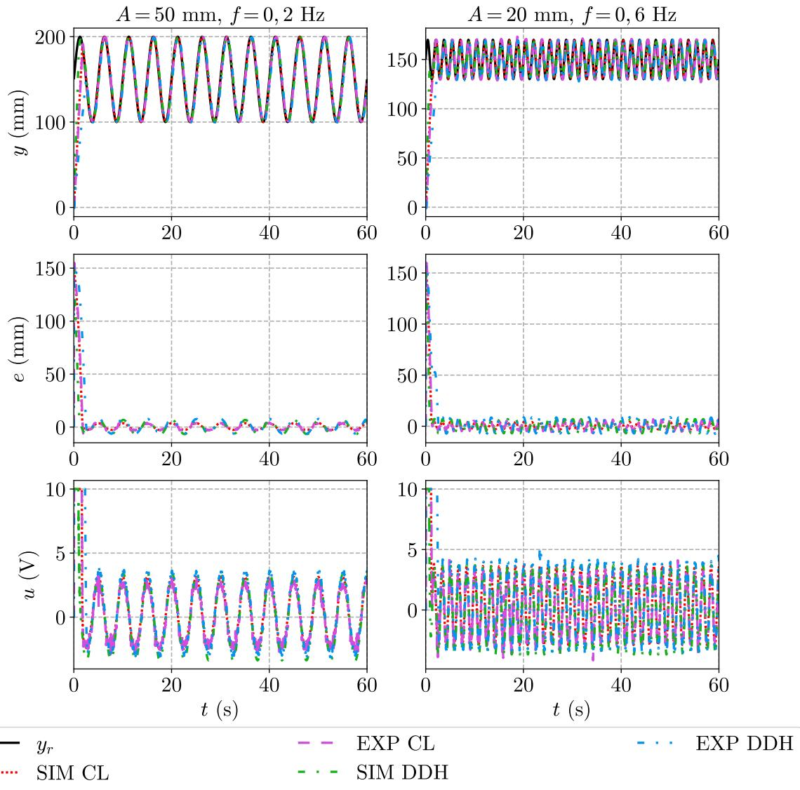
Slika 5.9: Backstepping regulator – usporedba simulacijskih i eksperimentalnih rezultata za sinusnu pobudu
