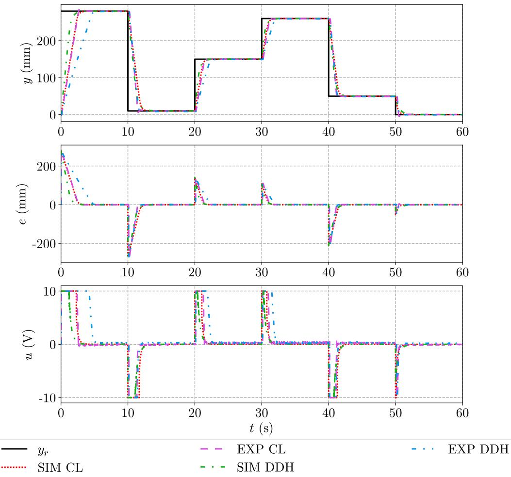
Slika 5.10: Backstepping regulator – usporedba simulacijskih i eksperimentalnih rezultata za skokovitu pobudu
