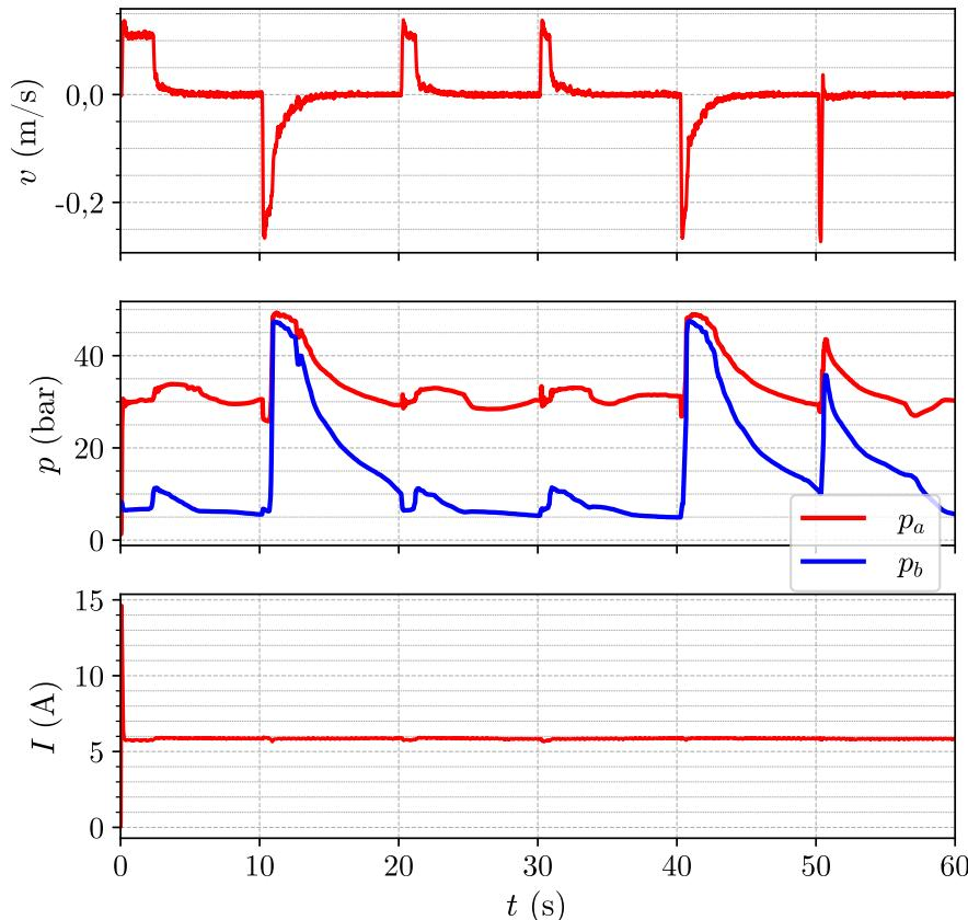
Slika 6.3: Primjer seta mjerene podataka klasičnog sustava za skokovitu pobudu i opterećenje od 200 kg
