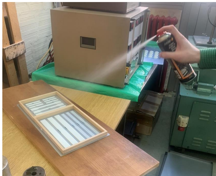
Slika 31. Prskanje kalupa PTFE sprejom
