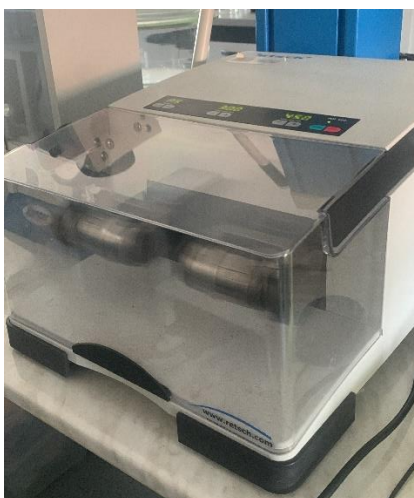
Slika 35. Mlin MIXER MILL MM 200
