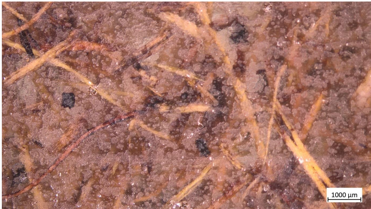
Slika 46. Mikrostruktura ispitka 7 – 10 % vlakana obrađivanih 5 dana u 15 %-tnoj otopini
