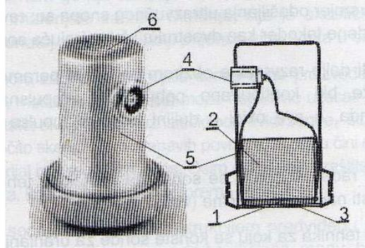
1 – pretvornik, 2- blok za prigušenje, 3 – zaštitna folija , 4 – priključnica, 5 – kućište, 6 – oznaka sonde
