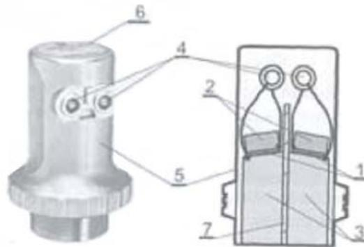
1- Pretvarač, 2 – blok za prigušenje, 3- blok za kašnjenje, 4 – priključnice, 5 – kućište, 6 – oznaka sonde, 7 – akustična izolacija
