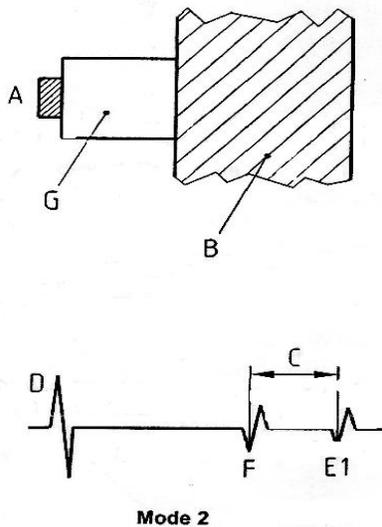
**Metoda jednostrukog odjeka sa blokom za kašnjenjem (Metoda 2)** – mjerimo vrijeme preleta za udaljenost od kraja bloka za kašnjenje pa do prvog odjeka od zadnje stijenke
