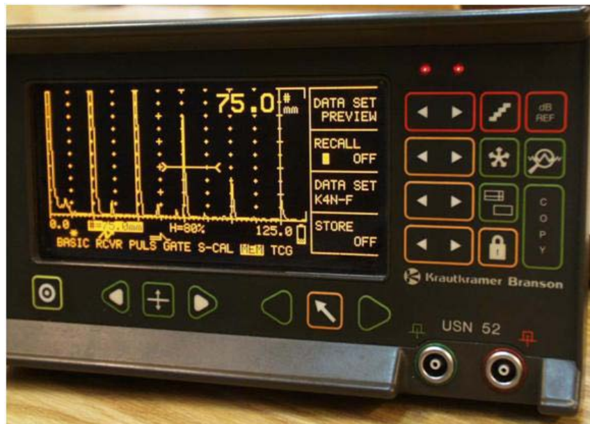
Slika 4. Ultrazvučni uređaj sa grafičkim i numeričkim prikazom mjerne vrijednosti
