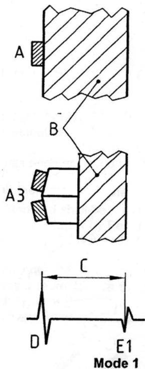
**Metoda jednostrukog odjeka (Metoda 1)** – mjerimo vrijeme preleta od prvog, pobudnog impulsa pa do prvog odjeka uzimajući u obzir debljinu zaštite pretvornika te debljinu kontaktnog sredstva ( zero correction )
