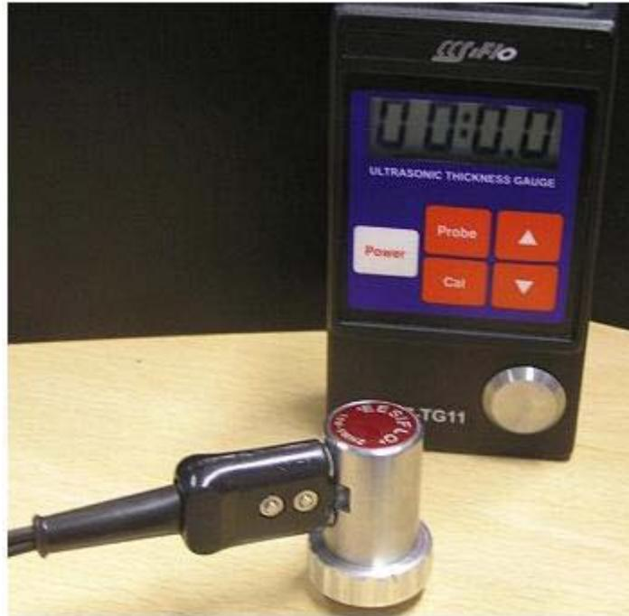
Slika 5. Ultrazvučni uređaj sa numeričkim prikazom mjerene vrijednosti
