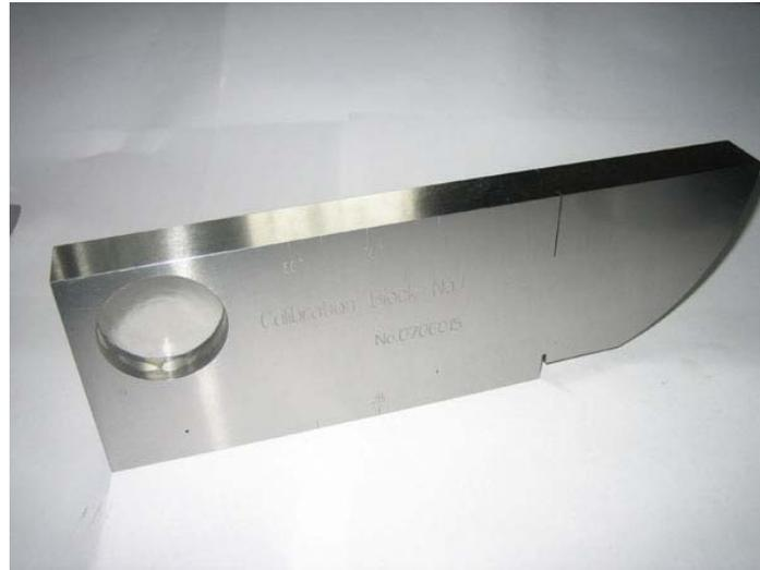
Slika 9. Referentni etalon V1
