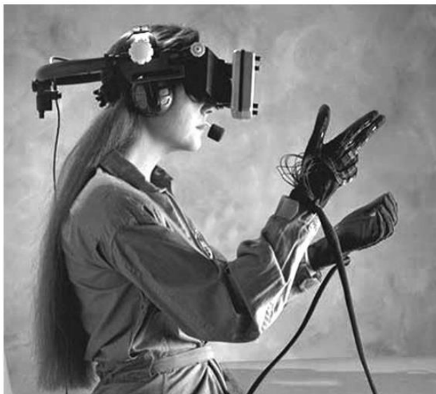
Slika 9. VR - stereoskopske naočale i rukavice s osjetnicama [20]
