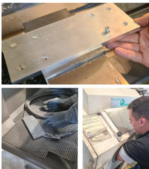
Slika 22. Kontrola i pjeskarenje
