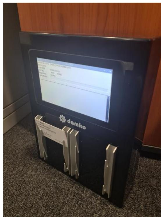
Slika 28. Konačni RFID uređaj
