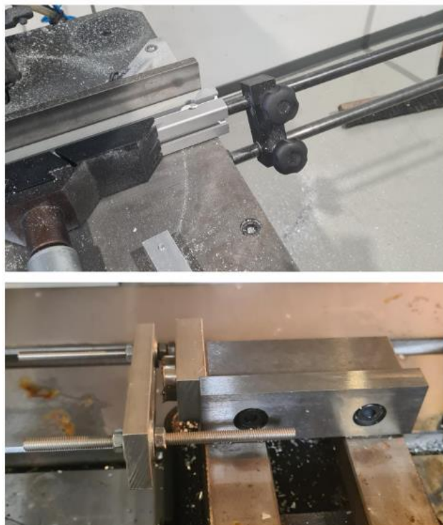
Slika 39. Graničnik na kružnoj pili i na CNC stroju
