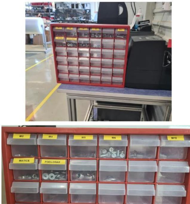
Slika 35. Kutija za vijke, matice i podloške postavljena unutar radne jedinice
