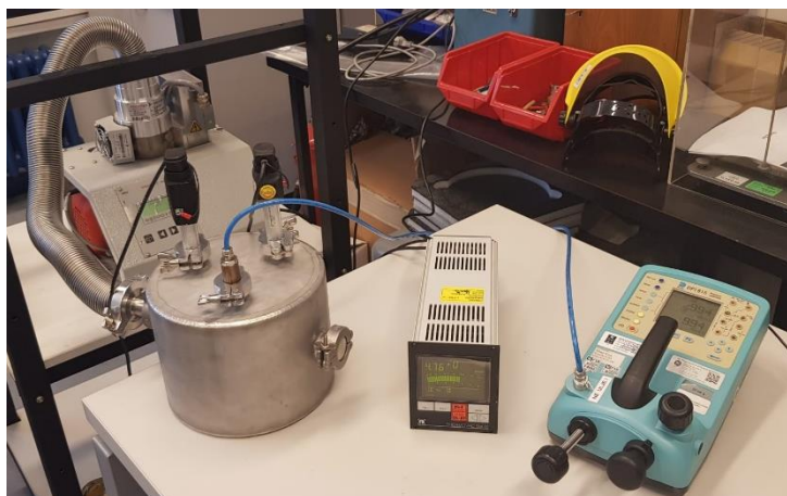
Slika 34. Mjerna linija za umjeravanje vakuummetra
