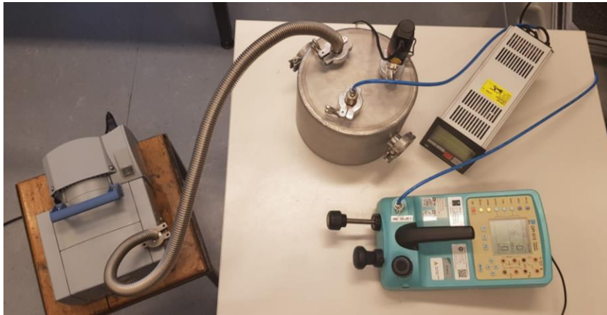
Slika 30. Spoj membranske pumpe na vakuum komoru
