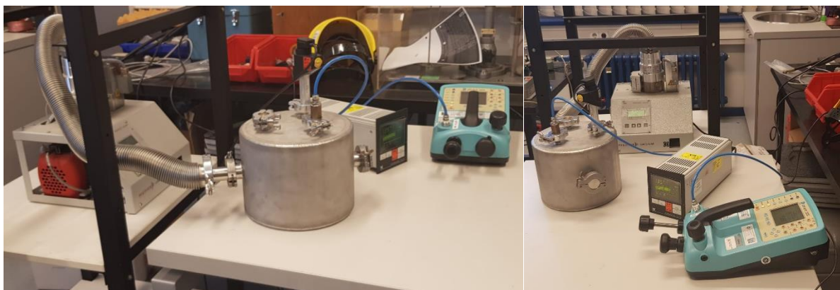
Slika 31. Spoj turbomolekularne pumpe na vakuum komoru
