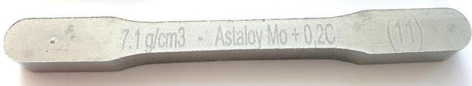
**Slika 24 Epruveta materijala Astaloy Mo+0,2C gustoće  $7,1 \text{ g/cm}^3$**
