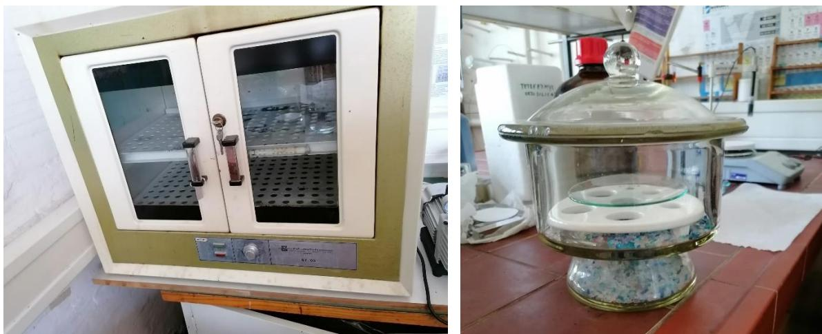
Slika 25 Prikaz sušionika (lijevo) i eksikatora (desno)
