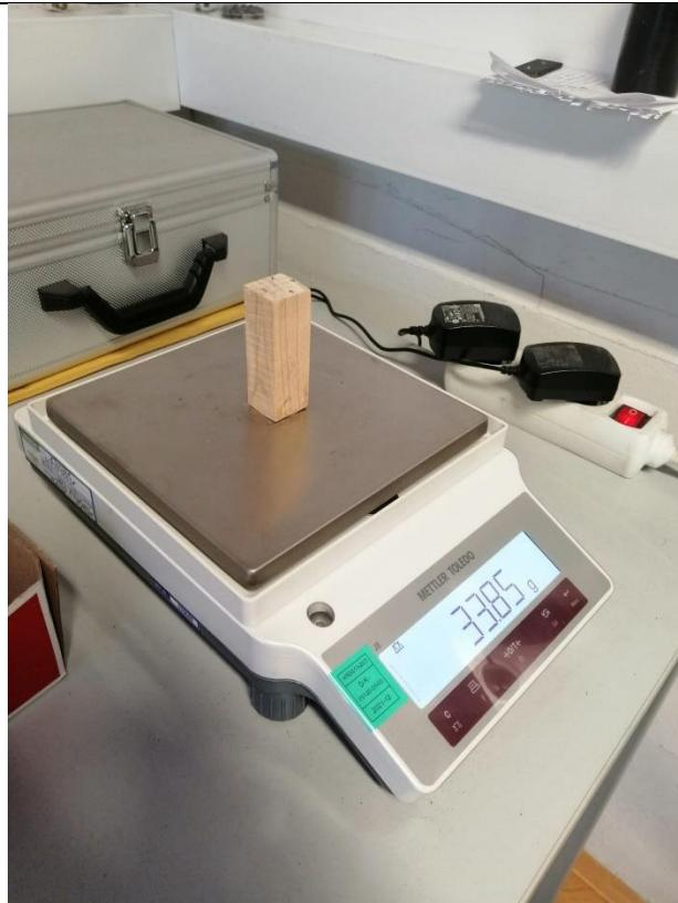
**Slika 24 Vaganje uzorka prije ispitivanja na abrazijsko trošenje**
