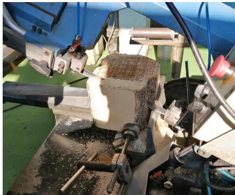
Slika 22 Prikaz procesa rezanja uzorka
