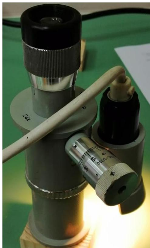
Slika 29 Uredaj na kojem se precizno mjeri promjer koji ostavi kuglica
