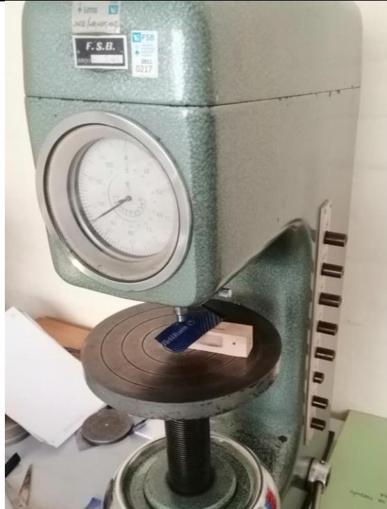
Slika 28 Proces mjerena tvrdoće na tvrdomjeru
