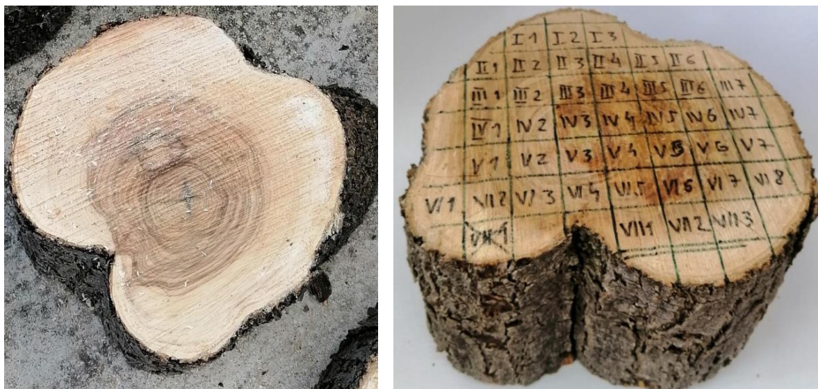
Slika 21 Poprečni presjek prije (lijevo) i nakon pozicioniranja uzoraka (desno)
