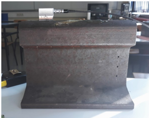
Slika 23. Detektiranje reflektora FBH 1 sondom MWB 45-2
