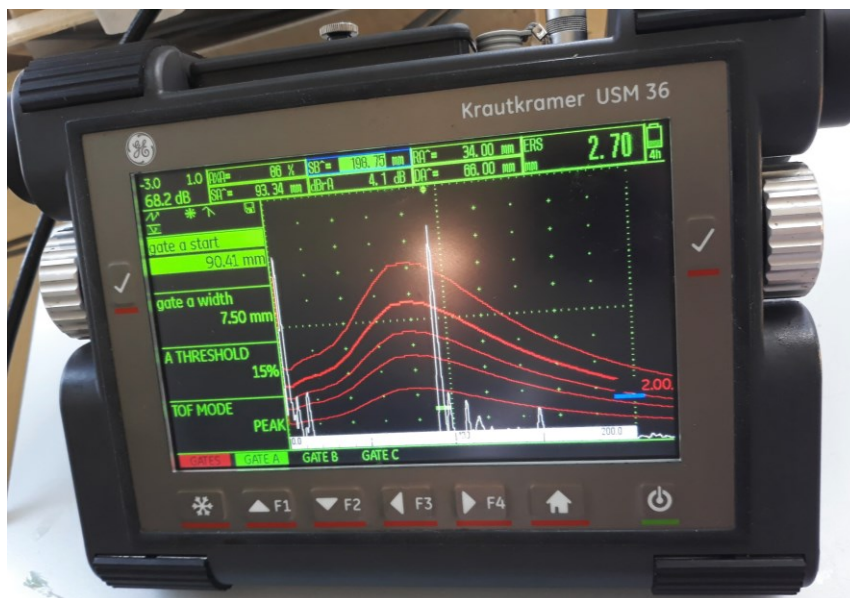
Slika 74. Ekran uređaja pri detektiranju SDH 1 sondom WB 45-2
