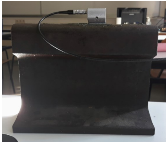
Slika 32. Detektiranje reflektora SDH 1 sondom MWB 45-2
