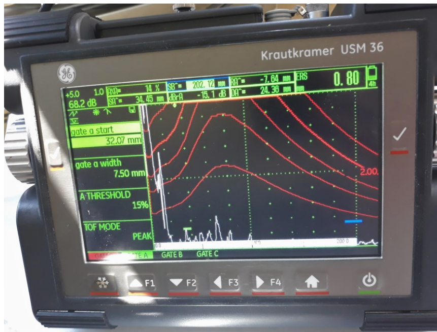
Slika 65. Ekran uređaja pri detektiranju FBH 1 sondom WB 45-2
