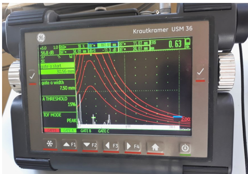
Slika 47. Ekran uređaja pri detektiranju FBH 1 sondom SWB 45-2
