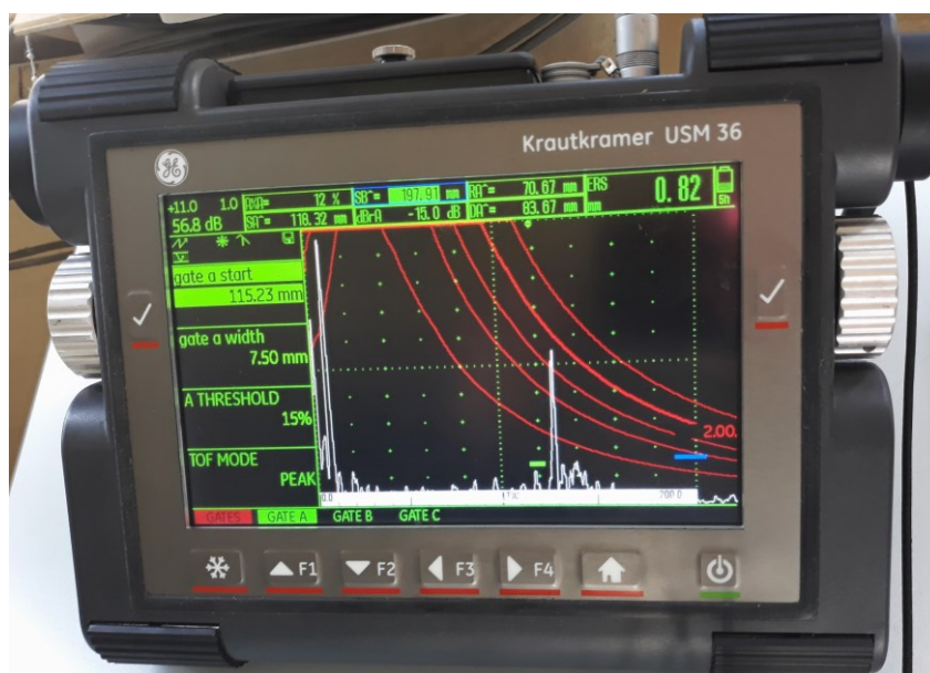
Slika 48. Ekran uređaja pri detektiranju FBH 2 sondom SWB 45-2
