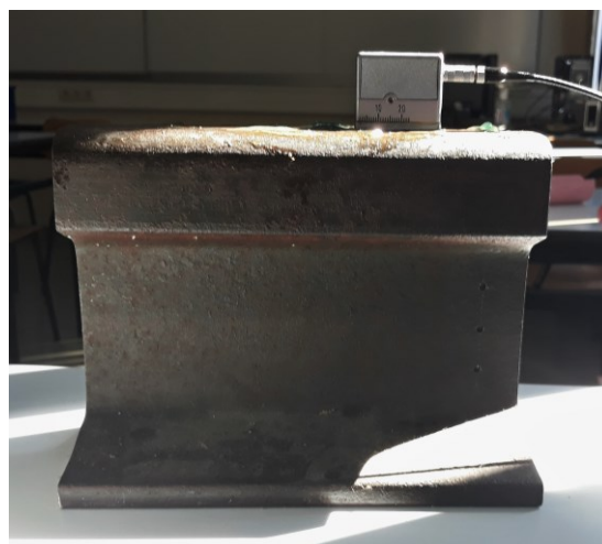
Slika 43. Detektiranje reflektora FBH 3 sondom SWB 45-2
