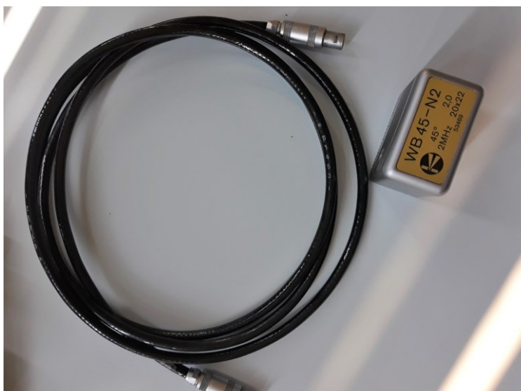
Slika 21. Kabel za spajanje sonde WB 45-2 s uređajem
