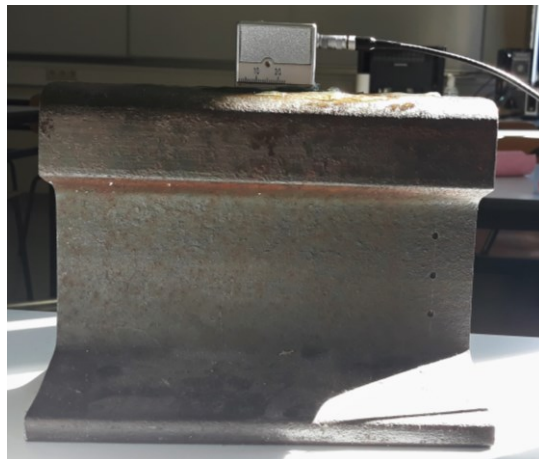
Slika 42. Detektiranje reflektora FBH 2 sondom SWB 45-2
