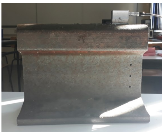
Slika 25. Detektiranje reflektora FBH 3 sondom MWB 45-2
