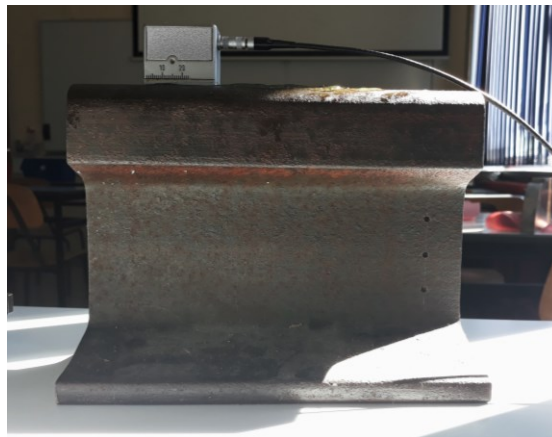
Slika 41. Detektiranje reflektora FBH 1 sondom SWB 45-2
