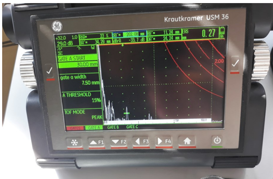
Slika 29. Ekran uređaja pri detektiranju FBH 1 sondom MWB 45-2
