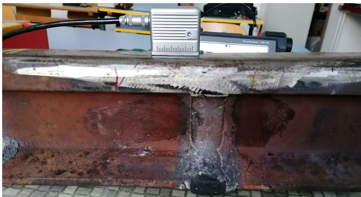
Slika 80. Položaj u kojem sonda WB 45-2 detektira pogrešku u glavi tračnice
