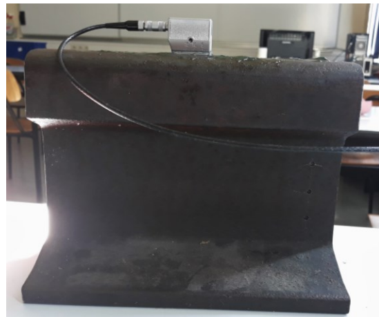
Slika 33. Detektiranje reflektora SDH 2 sondom MWB 45-2
