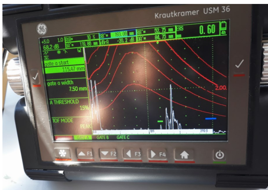
Slika 66. Ekran uređaja pri detektiranju FBH 2 sondom WB 45-2
