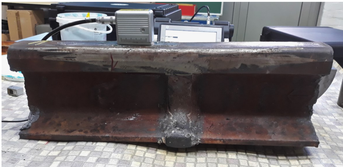
Slika 86. Položaj u kojem sonda WB 45-2 detektira pogrešku u vratu tračnice
