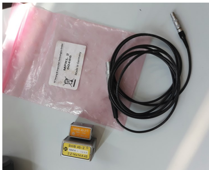
Slika 20. Kabel MPKL 2 za spajanje sonde MWB 45-2 i SWB 45-2 s uređajem
