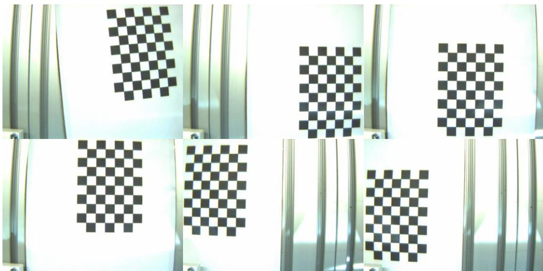
Slika 26. Kalibracija kamere pomoću 7x10 kalibracijske šahovnice
