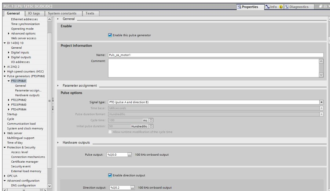
Slika 20. Omogućavanje PTO generatora impulsa
