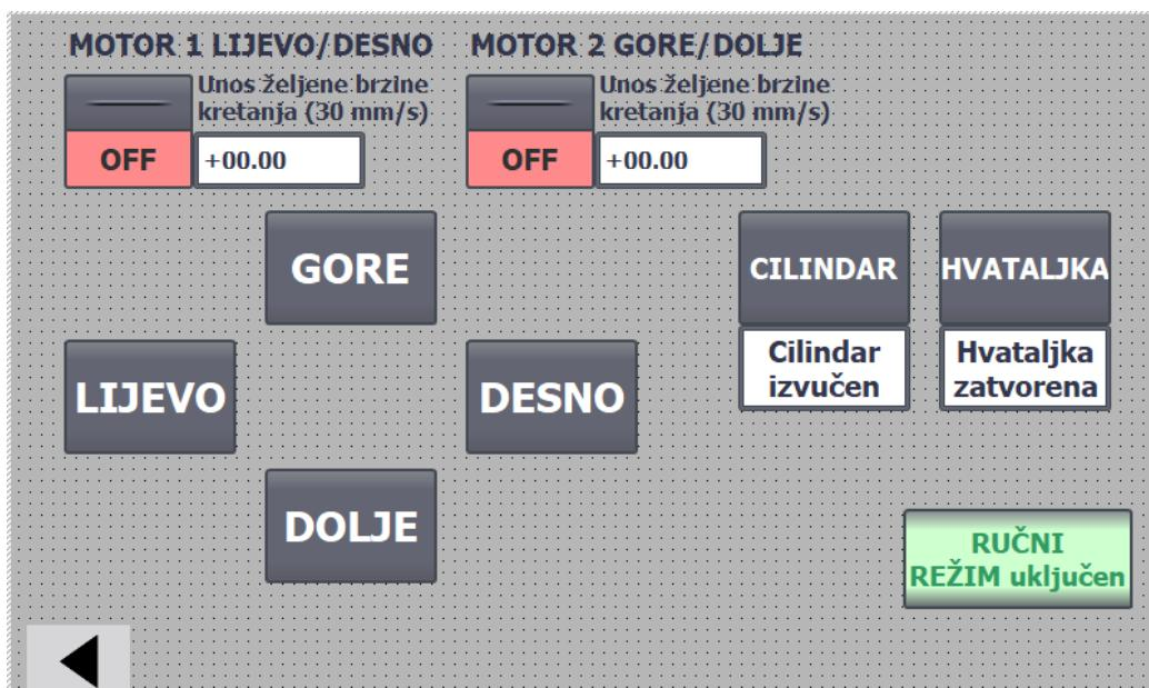
Slika 31. HMI prikaz drugog ručnog režima rada
