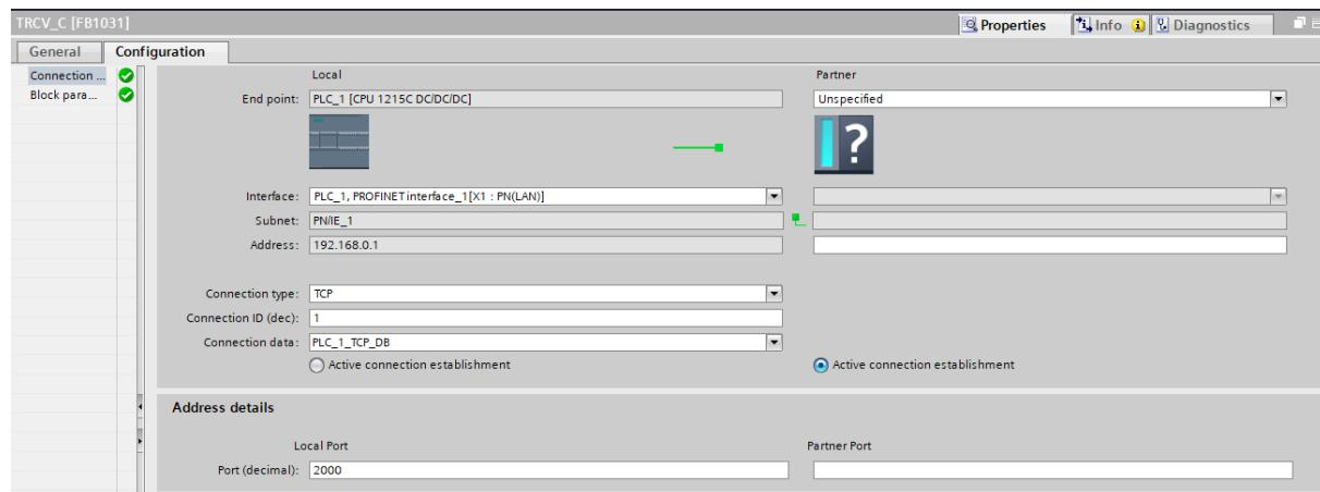
**Slika 25. Konfiguracija TCP/IP komunikacije od strane PLC-a**
