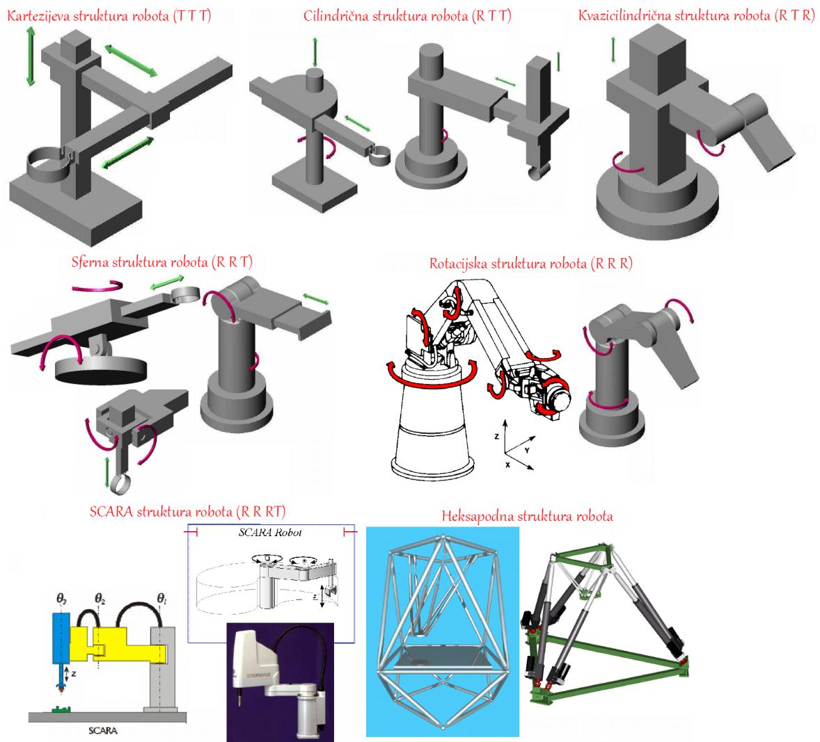
Slika 1. Moguće strukture robota i manipulatora [2]
