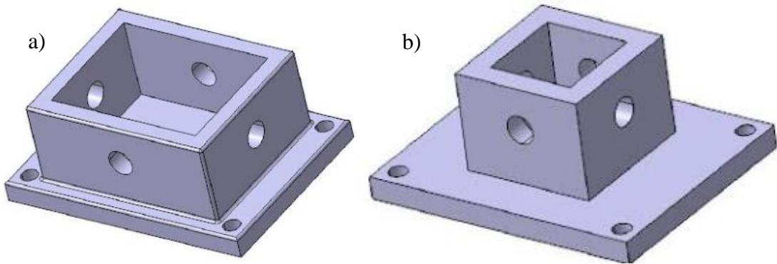
**Slika 11.** a) CAD model za spoj IGUS kliznog nosača i 45x60 aluminijskog profila,
