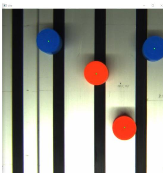
**Slika 28. Prikaz detektiranih predmeta rada kalibrirane kamere s označenim središtim**
