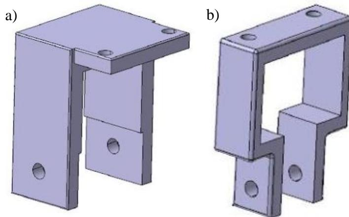
**Slika 12.** a) CAD model za spoj manje IGUS vodilice i 45x60 aluminijskog profila,
