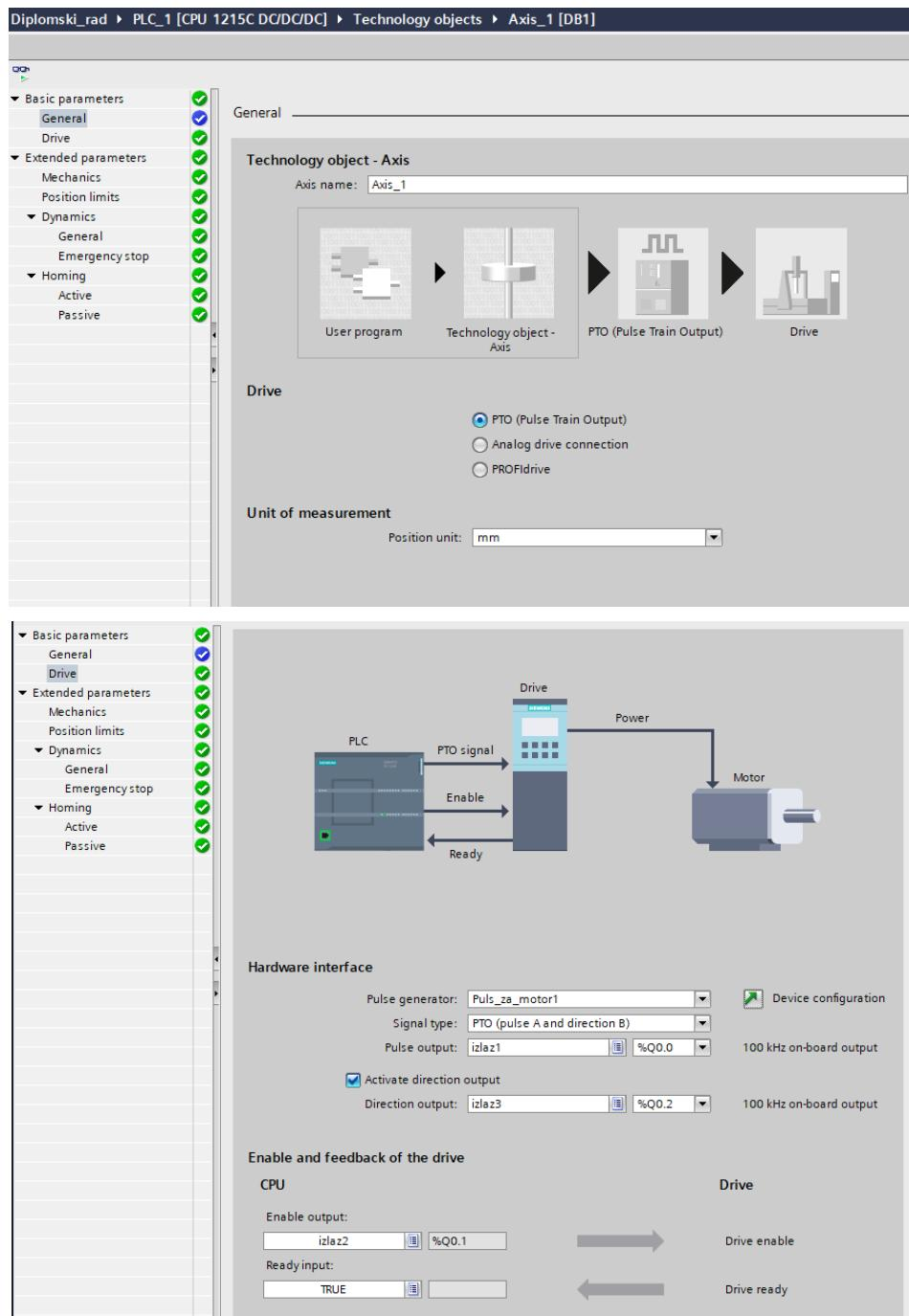
Slika 21. Osnovni parametri tehnološkog objekta pozicioniranja po osi
