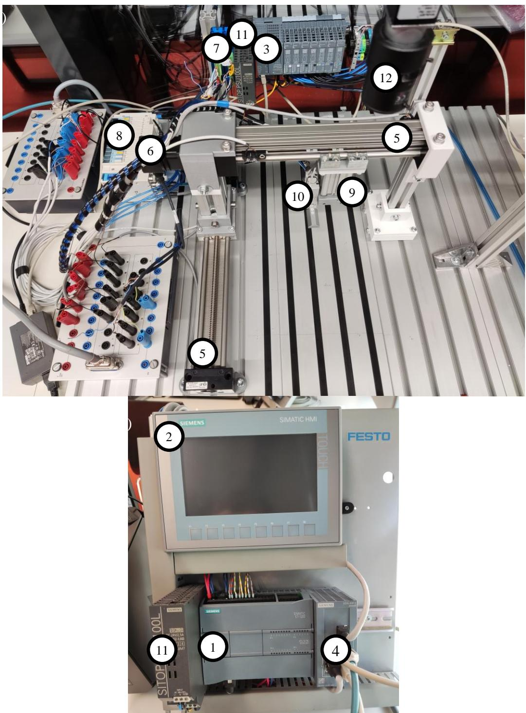
**Slika 4.** Postav portalnog manipulatora: a) 3-Distribuirani I/O, 5-Linearna vodilica, 6-Koračni motor, 7-Motor kontroler, 8-Pneumatski blok, 9-Pneumatski cilindar, 10-Pneumatska hvataljka, 11-Izvor napajanja, 12-Kamera; b) 1-PLC, 2-HMI, 4-Preklopnik, 11-Izvor napajanja
