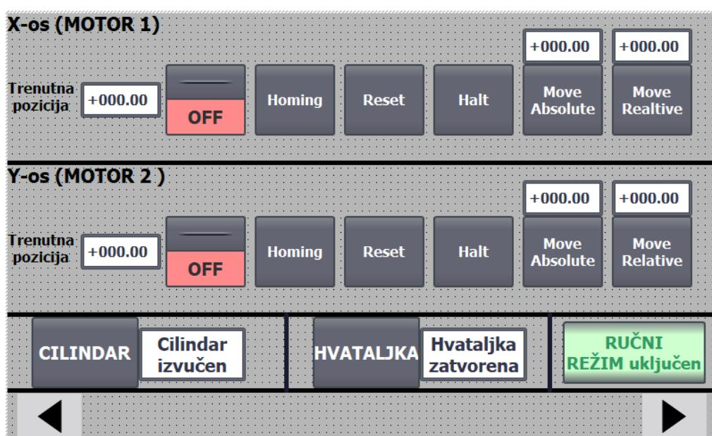
Slika 30. HMI prikaz prvog ručnog režima rada
