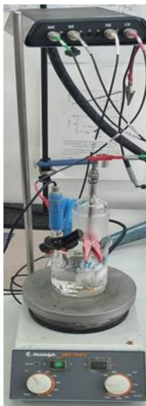
Slika 16. Elektrokemijska ćelija s elektrodama
