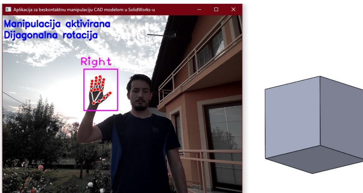
Slika 102. Testiranje dijagonalne rotacije CAD modela
