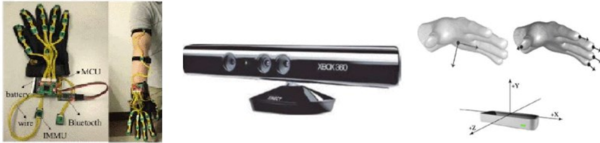
Slika 48. Uređaji za prepoznavanje šaka i prikupljanje podataka, [47]
