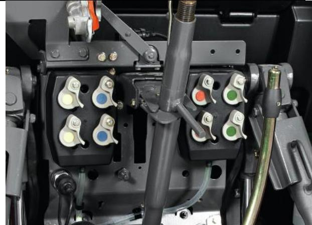
Slika 9. Hidraulični izvodi na traktoru
