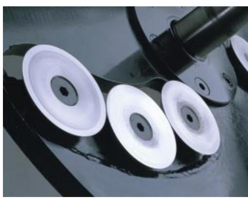
**Slika 21.** „Disc-blade“ noževi
