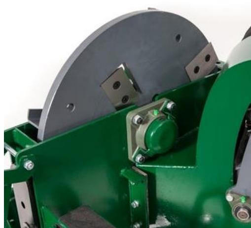
**Slika 14. Noževi na zamašnjaku**
