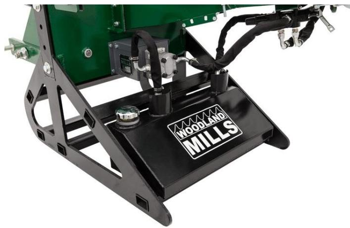
**Slika 18. Hidraulična pumpa i spremnik za hidrauličnu tekućinu**
