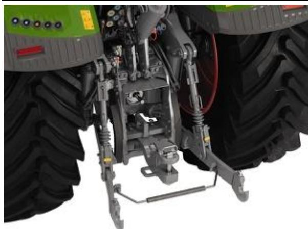
Slika 8. Hidraulična poteznica
