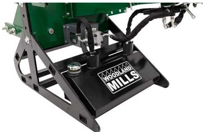
Slika 18. Hidraulična pumpa i spremnik za hidrauličnu tekućinu
