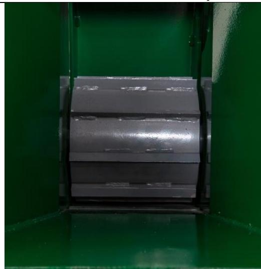
**Slika 17. Valjak za povlačenje drvne mase**
