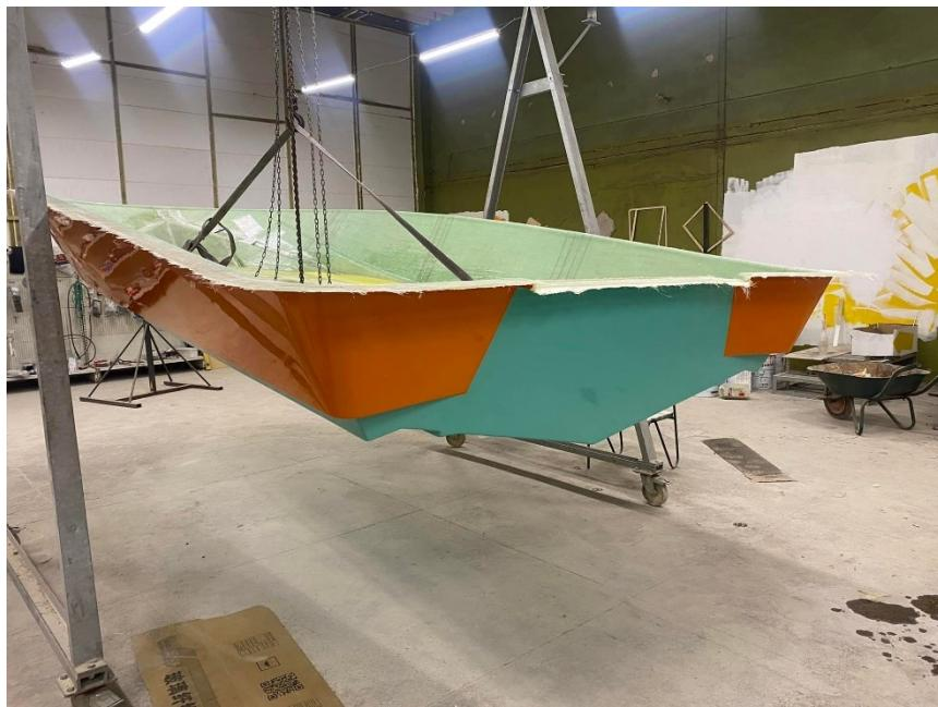
Slika 5.6. Izrada ribičkog broda postupkom ručnog laminiranja [24]
