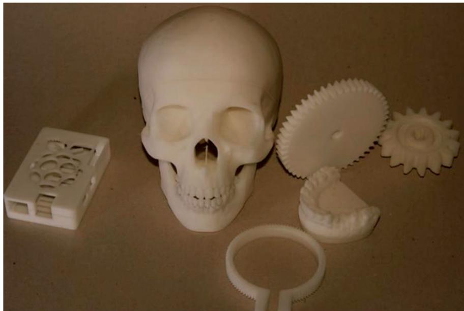
Slika 3.1. Primjeri proizvoda izrađenih postupkom FDM [8]
