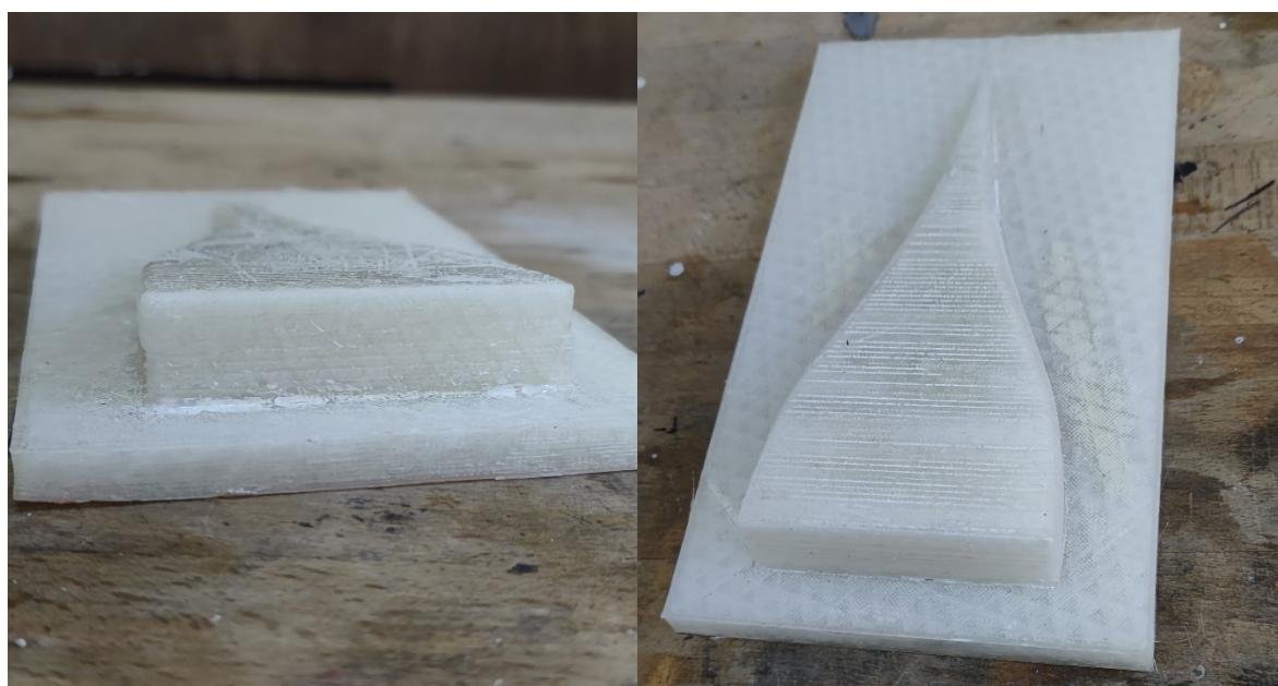
Slika 7.4. Kalup ispisan postupkom FDM: a) s greškom pomicanja slojeva, b) bez greške
