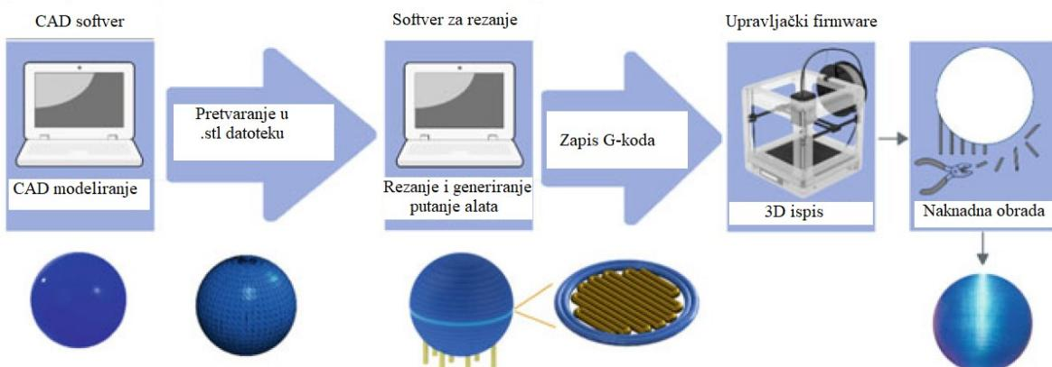
Slika 3.2. Tijek postupka izrade postupkom FDM [7]
