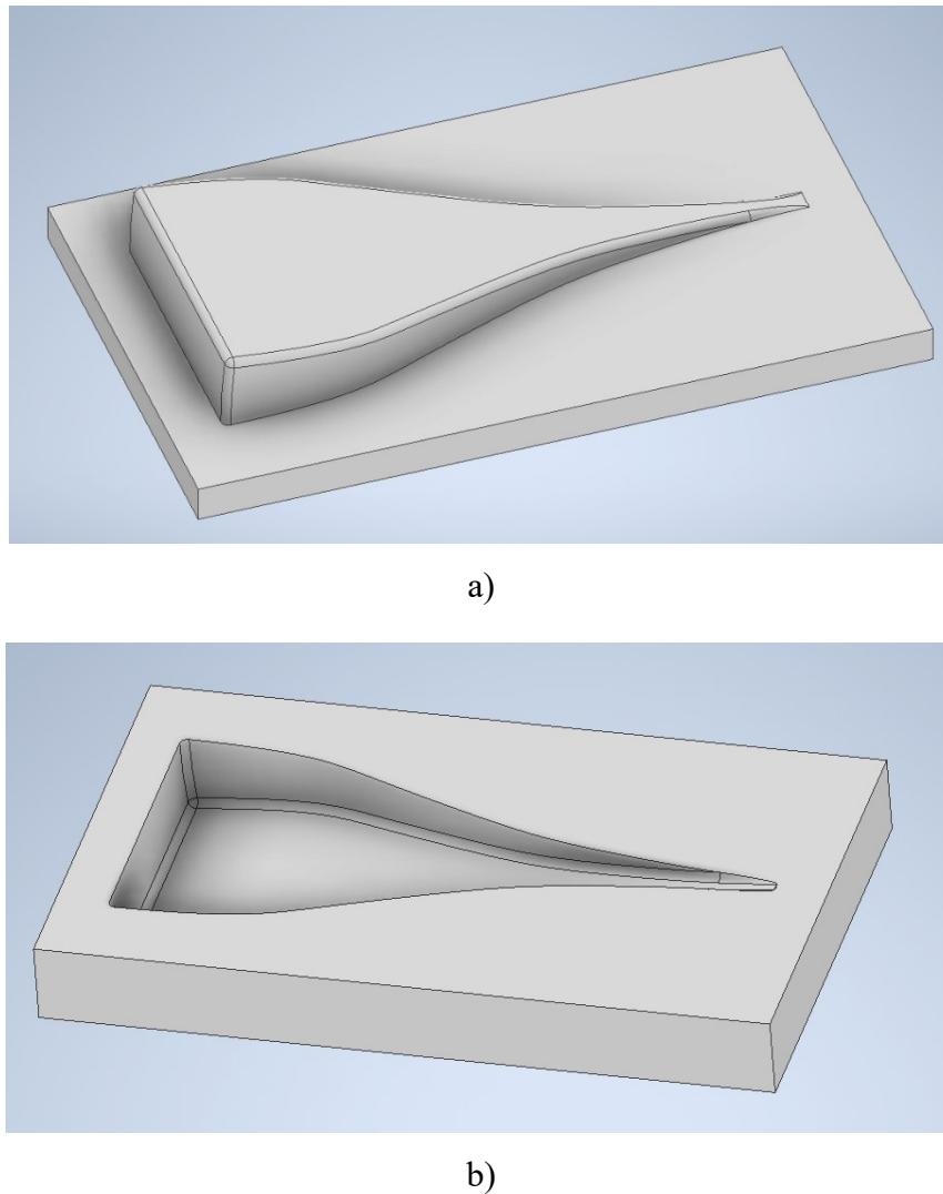
Slika 7.2. Izrađeni CAD modeli kalupa: a) pozitivni oblik kalupa - za polaganje kompozitnog materijala na vanjsku stranu kalupa, b) negativni oblik kalupa - za ulaganje kompozitnog materijala u unutarnju stranu kalupa
