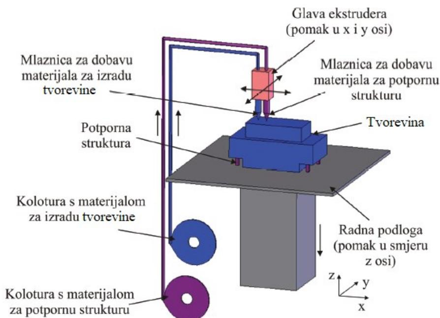
Slika 3.3. Shematski prikaz postupka taložnog očvršćivanja [10]
