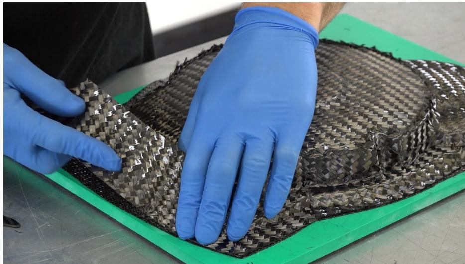
Slika 5.7. Polaganje slojeva ugljičnog preprega na otvoreni kalup [25]
