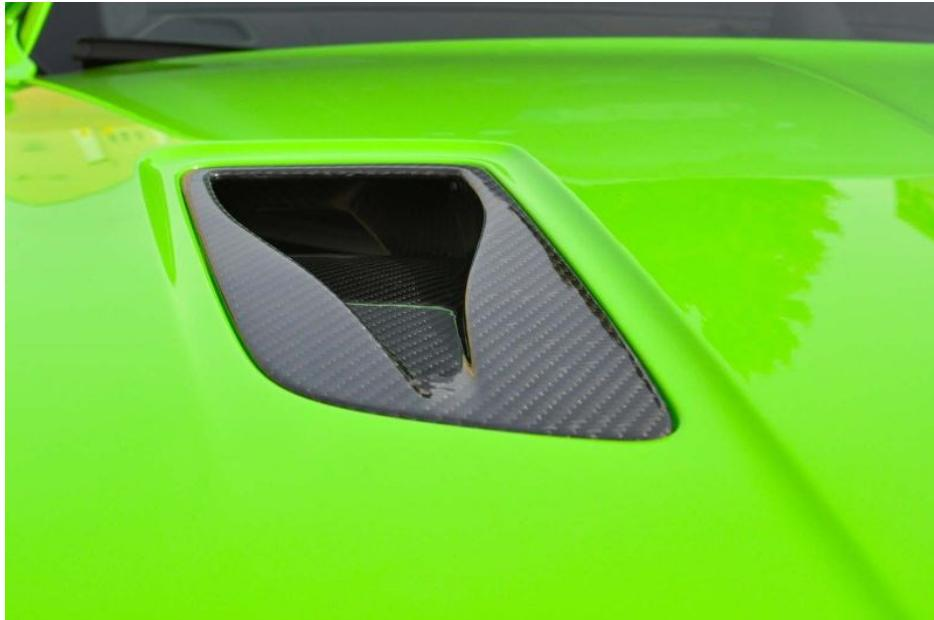
Slika 7.1. Primjer *NACA* usisnika izrađenog od kompozitnog materijala [37]
