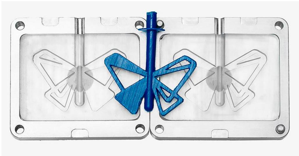
Slika 6.2. Ispisani kalup umetnut u aluminijski potporni okvir [29]
