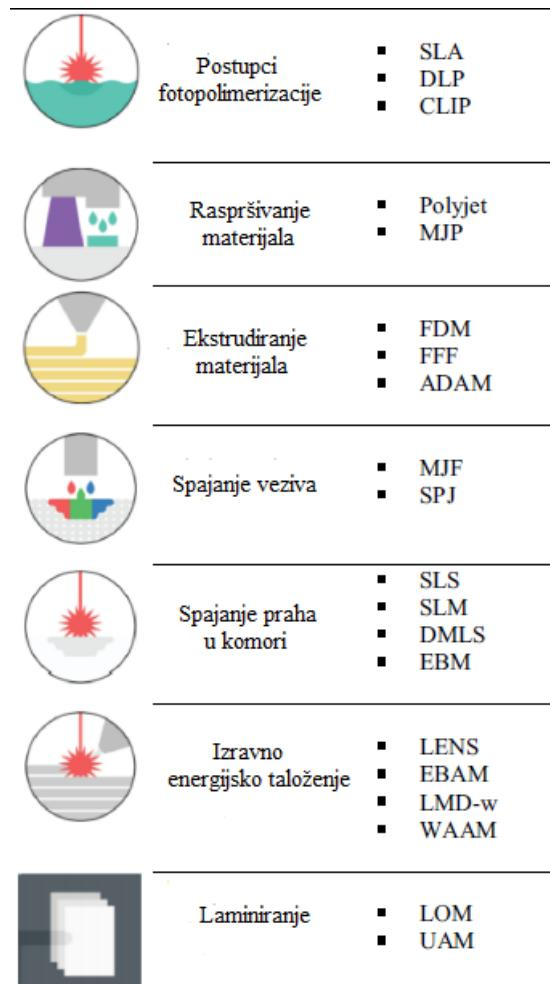
Slika 2.3. Podjela postupaka aditivne proizvodnje prema ASTM [6]
