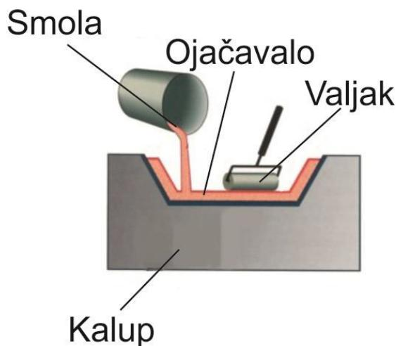
Slika 5.5. Shematski prikaz ručnog laminiranja [23]
