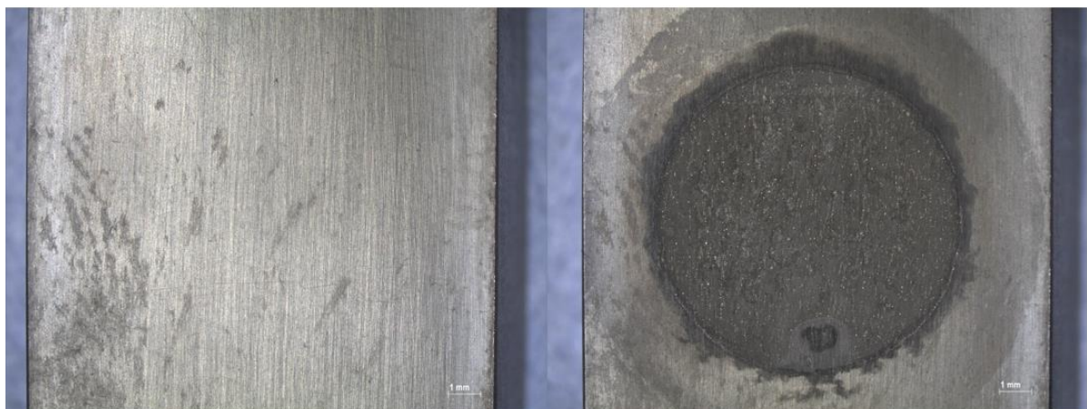
Slika 28. Izgled površine uzorka A3 prije i nakon elektrokemijskih ispitivanja pod povećanjem od 7.88x
