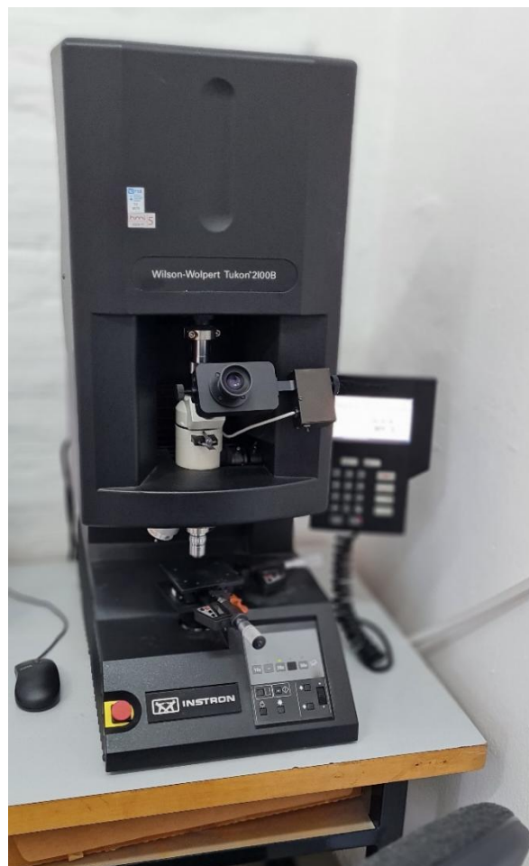
Slika 17. Uređaj Wilson-Wolpert Tukon 2100B – Instron za ispitivanje tvrdoće prema metodi Vicker
