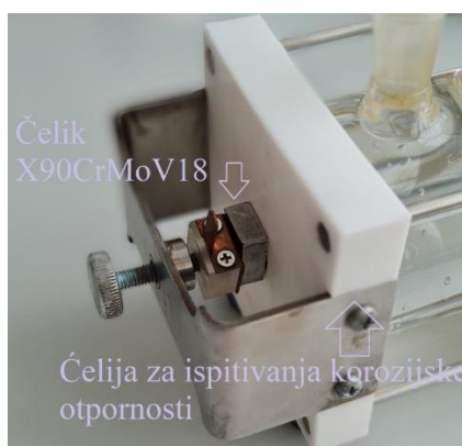
Slika 22. Uzorak postavljen na ćeliji za ispitivanje korozijske otpornosti
