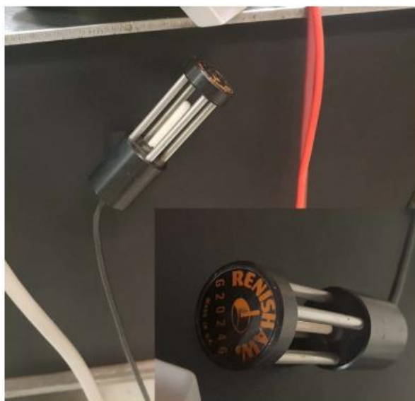
Slika 20. Mjerni senzor kompenzacijskog uređaja [13]
